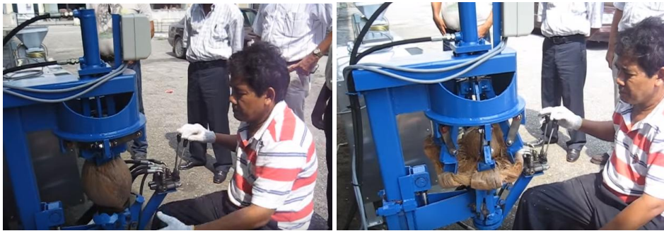
Şekil 2.5: Motorlu meyve dış kabuğu uzaklaştırma makinası (Youtube 2008).
