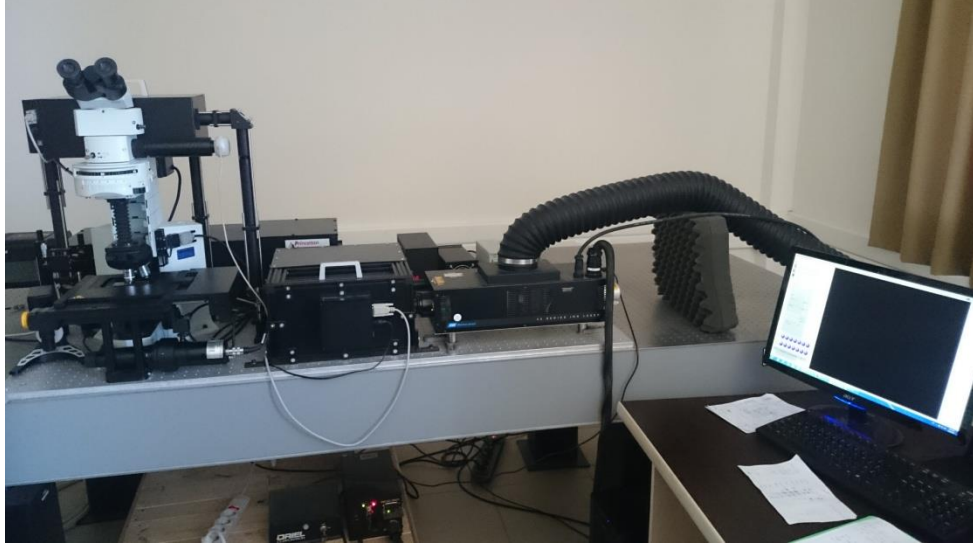
Şekil 4.28: İYTE Laboratuvarında bulunan ve tez kapsamında kullanılan Raman mikroskobu (Monovista CRS 750/BX51).
