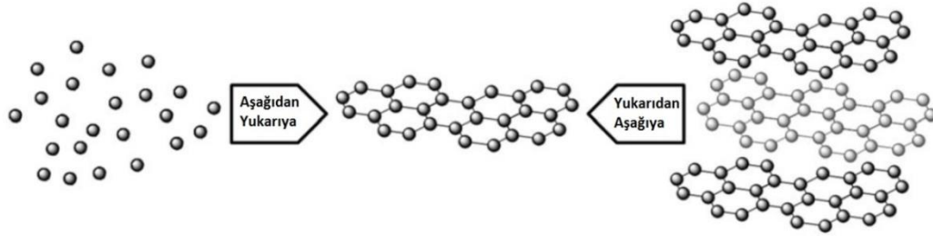
Şekil 2.13: Grafenin aşağıdan yukarıya ve yukarıdan aşağıya yaklaşımlarına göre üretim şematiği (Edwards ve Coleman 2013).
