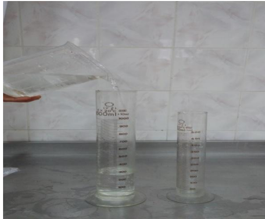
Şekil 3.5 Silindirik ölçüm kaplarıyla ölçümün yapılması
