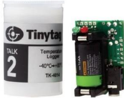
Şekil 2.5: Sıcaklık kaydı için kullanılan cihaz "Tinytalk 2".
