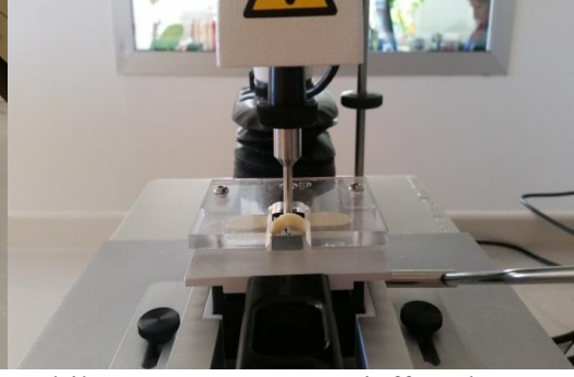
Şekil 2.4: Hamurun Kieffer düzeneğinde uzatılması
