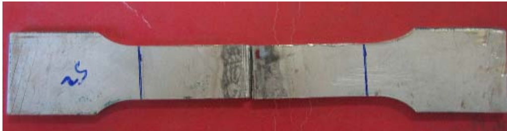
Şekil 7.4 1000 \text{ min}^{-1} devir sayısı 50 mm/min ilerleme hızı ve takım dalış açısı 1^\circ45'' parametreleri ile elde edilen Numune 4 çekme deneyi sonrası
