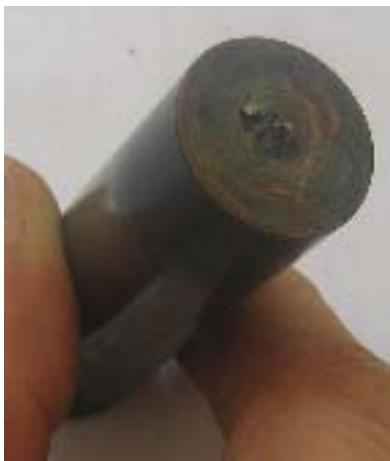
Şekil 6.3 SKK son denemelerinde kullanılan batıcı uçların uygulama sırası ve sonrasında takım aşınmaları
