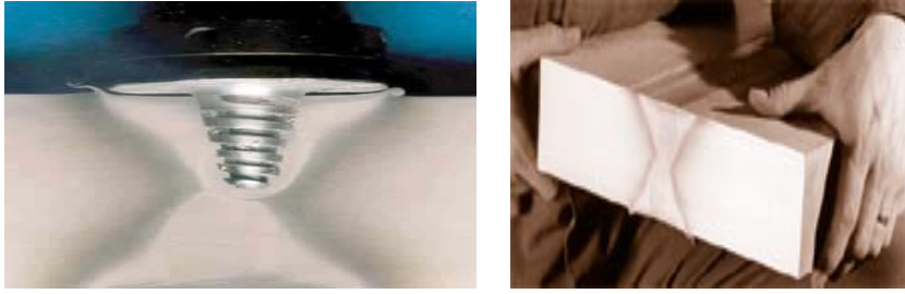
Şekil 4.14 75mm kalınlığındaki AA 6082-T6 alaşımının kaynağında Whorl™ takımının kullanılması, kaynağın bitmiş hali ve kaynak dikişinin görüntüsü (Thomas vd 2001)
