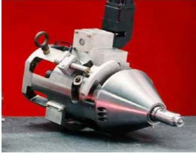
Şekil 4.40 Pim uzunluęu ayarlanabilen takım tasarımı (Mendez ve Eagar 2002)
