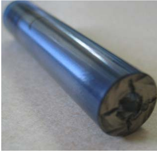
Şekil 6.2 SKK ikinci denemelerinde kullanılan batıcı uçların uygulama sonrası görünümleri
