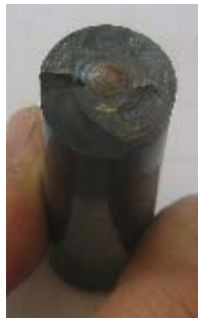
Şekil 6.3 SKK son denemelerinde kullanılan batıcı uçların uygulama sırası ve sonrasında takım aşınmaları
