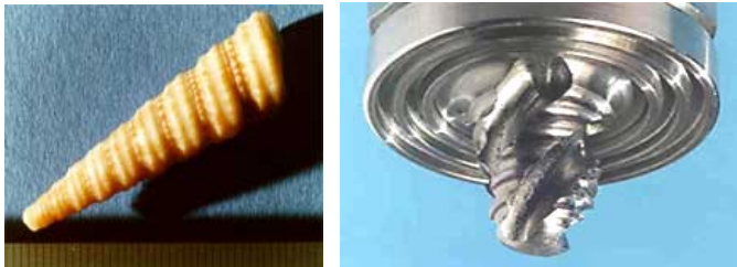
Şekil 4.15 Esin kaynağı deniz kabukları olan MX Triflute™ serisi pimlerin resim ve şematik çalışma şekli (Nicholas ve Kallee 2000)
