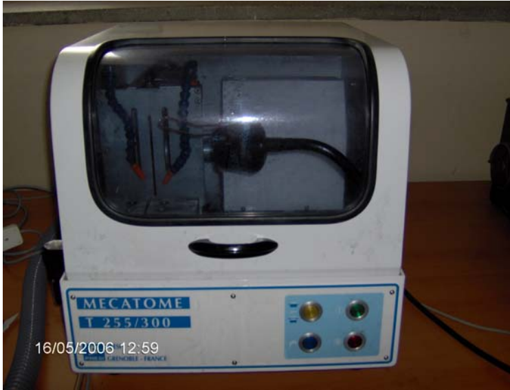
Şekil 7.7 Mecatome T 255/100 Marka sulu testere.
