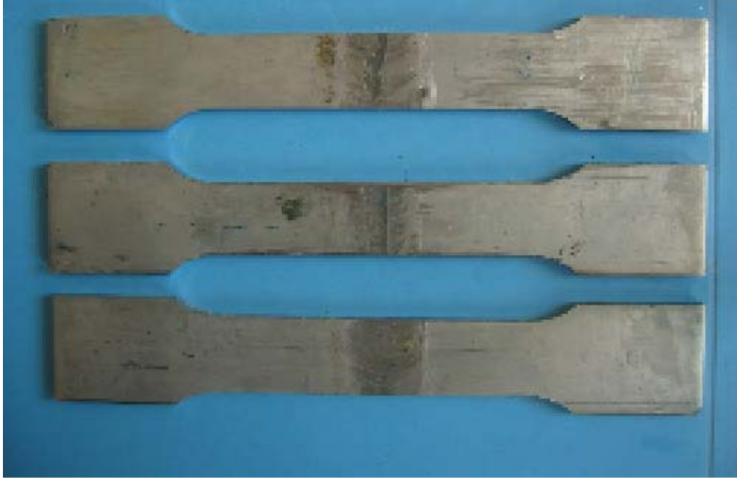
Şekil 7.2 1000 \text{ min}^{-1} devir sayısı 63 \text{ mm/min} ilerleme hızı ve takım dalış açısı 1^{\circ}45'' parametreleri ile elde edilen Numune 7'e ait çekme deneyi numuneleri görülmektedir
