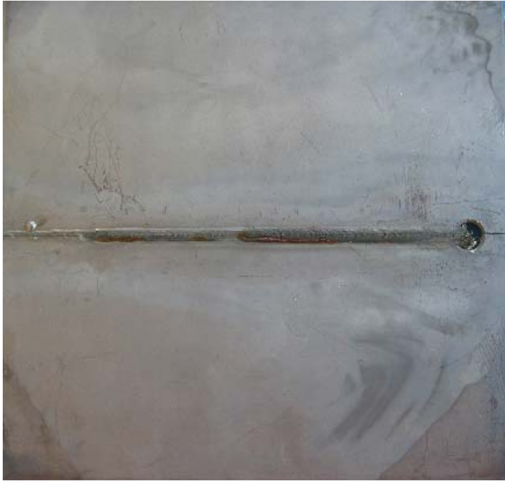
Şekil 6.6 710 \text{ min}^{-1} devir sayısı 40 \text{ mm/min} ilerleme hızı ve dik takım dalışı parametreleri ile elde edilen SKK denemesi alt yüzey nüfuziyeti
