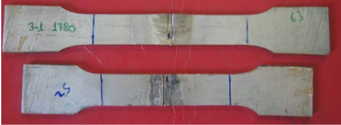
Şekil 7.6 Numune 4 ve 7 çekme deneyi sonrası uzama karşılaştırılması
