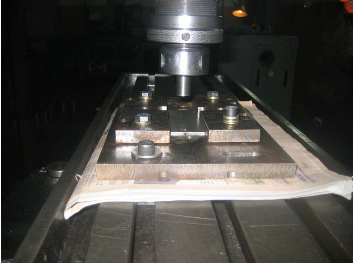
Şekil 5.2 SKK yapılacak parçaları tutan aparat
