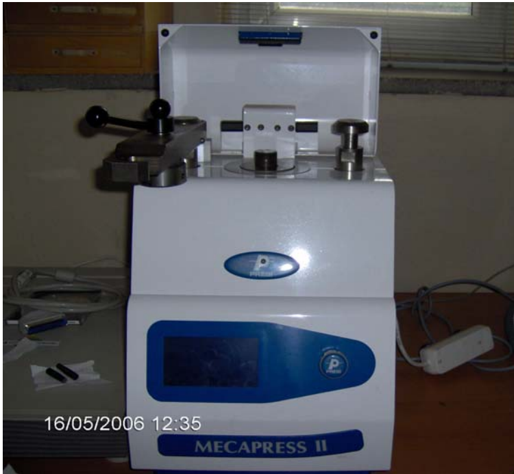
Şekil 7.8 MECAPRESS II Marka bakalite alma makinesi
