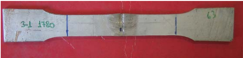
Şekil 7.5 1000 \text{ min}^{-1} devir sayısı 63 mm/min ilerleme hızı ve takım dalış açısı 1^\circ45'' parametreleri ile elde edilen Numune 7 çekme deneyi sonrası
