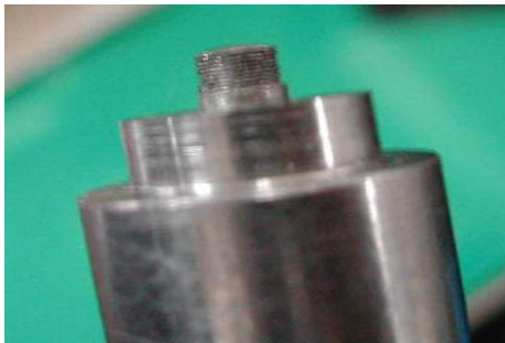
Şekil 4.12 SKK 'da kullanılan basit tip kaynak takımı (WEB_9 2003)
