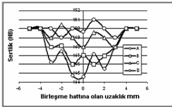
Şekil 4.11 Farklı takım pimi geometrilerinin kullanımı ile Al 1018 malzemesinin SKK ile birleştirilmiş numunelerin birleşme hattına dik doğrultuda yapılmış olan mikrosertlik ölçüm sonuçları (Özdemir ve Taşkın 2004)
