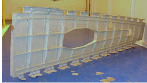
Şekil 4.21 SKK ile imal edilen Airbus A340-600 ve A380 modellerinde kanat kaburgaları (Shepherd 2004)
