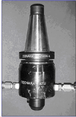
Şekil 4.43 Tecnara şirketi tarafından geliştirilen soğutuculu özel takım tutucu (Sorensen 2004).
