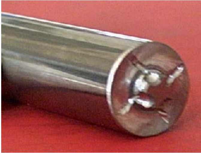
Şekil 5.6 SKK denemelerinde kullanılan yarıklı pimli batıcı uç
