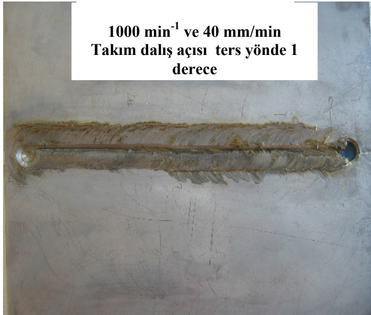
Şekil 6.4 1000 min -1 devir sayısı 40 mm/min ilerleme hızı ve takım dalış açısı -1 derece parametreleri ile elde edilen SKK denemesi üst yüzeyi
