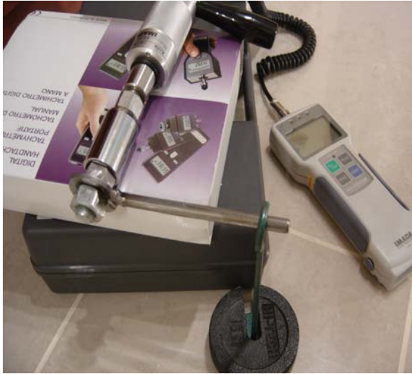
Şekil 5.17 Moment ölçme cihazının kalibrasyonu
