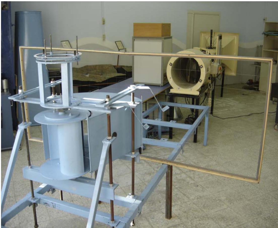
Şekil 5.2 Savonius rüzgar çarkı deney düzeneği resmi
