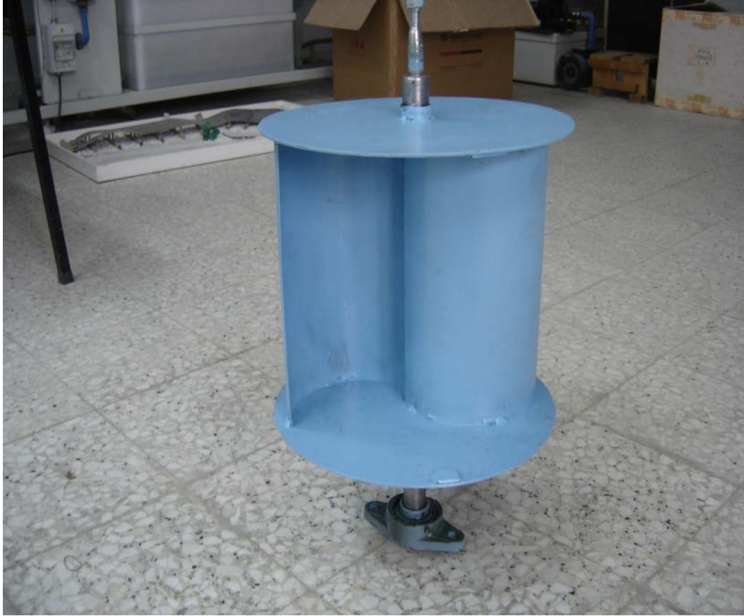
Şekil 5.4 İmal edilen Savonius rüzgar çarkı
