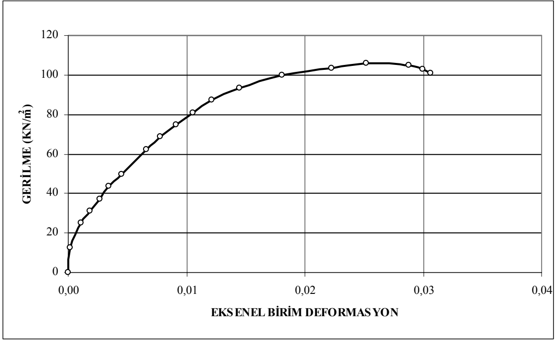
Şekil 4.30: %10 bentonit katkıli karışımın 1 hafta sonra kırılması durumunda gerilme-eksenel birim deformasyon ilişkisi
