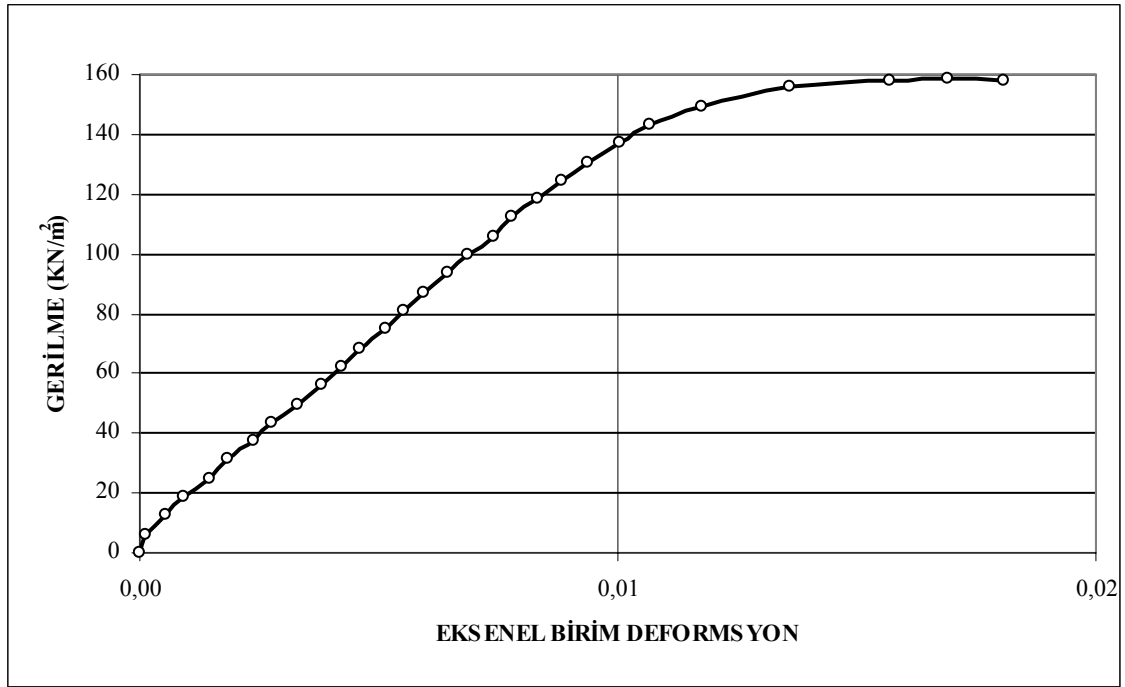
Şekil 4.44: %10 bentonit + %5 çimento katkıli karışımın hemen kırılması durumunda gerilme-eksenel birim deformasyon ilişkisi
