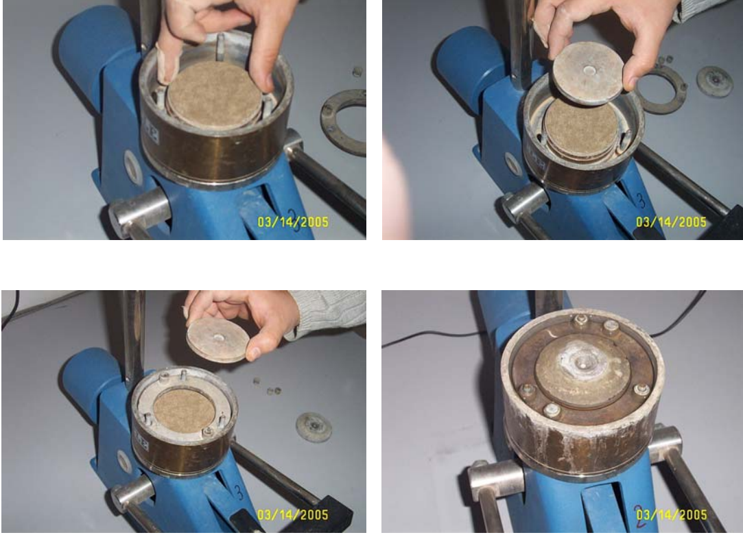
Şekil 4.71: Numune halkasının ödometreye yerleştirilmesi
