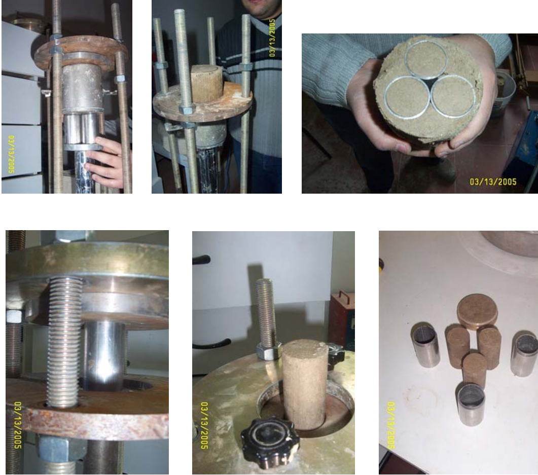
Şekil 4.25: Serbest basınç deneyi için numune hazırlama aşamaları
