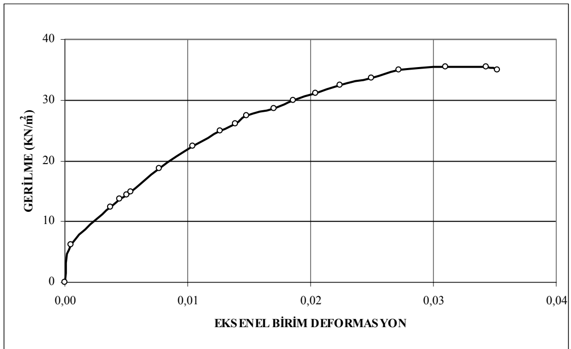
Şekil 4.47: %100 kumun hemen kırılması durumunda gerilme-eksenel birim deformasyon ilişkisi
