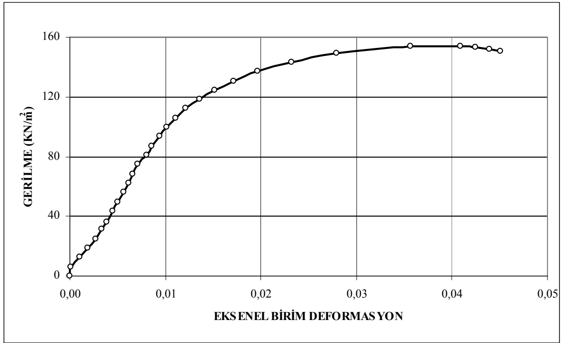
Şekil 4.34: %10 bentonit katkıli karışımın 28 gün sonra kırılması durumunda gerilme-eksenel birim deformasyon ilişkisi
