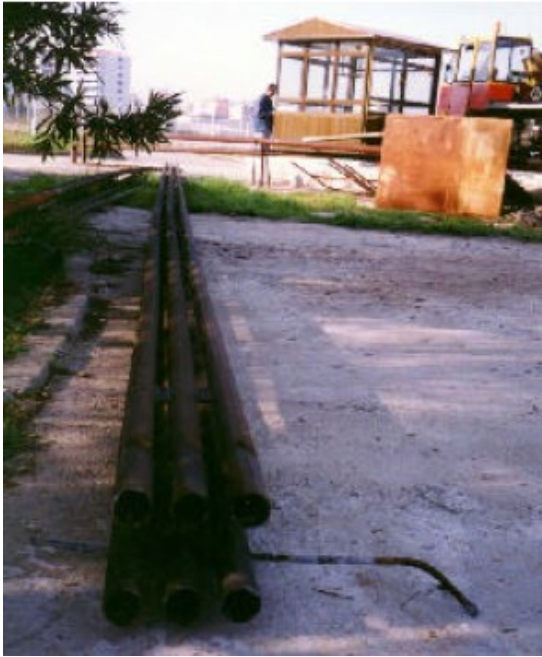
Şekil 5.13 Kuyu içi ısı eşanjöründe kullanılan borular (Lund 1999)
