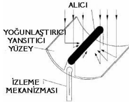
Şekil 3.7 Silindirik-parabolik yoğunlaştırıcı temel prensibi (Beerbaum ve Weinrebe 2000)
