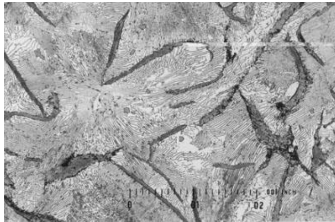
Şekil 3.1. Lamel grafitli dökme demir içinde mangan alaşım elementi (560X) (WEB_5 2004)
