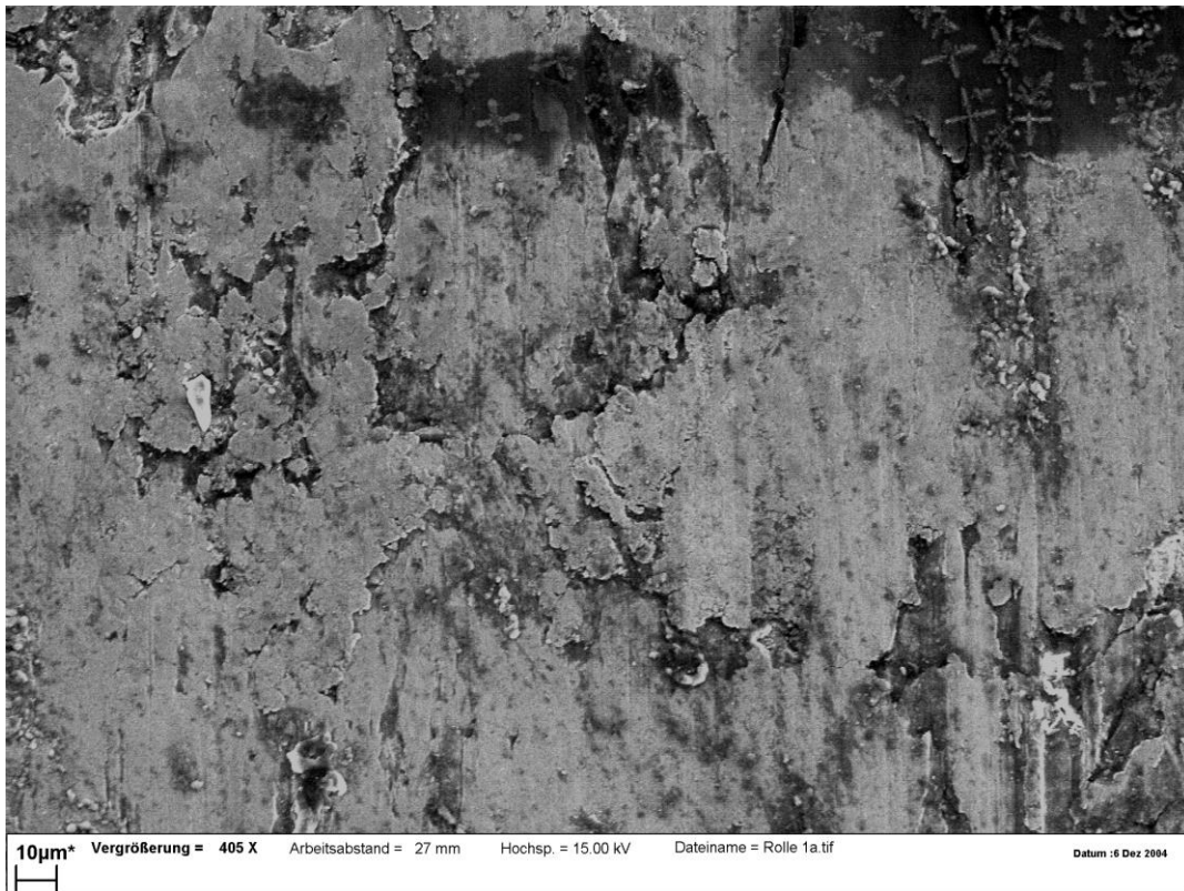
Şekil 6.18. 1 numaralı numunenin (ET1) aşınma sonrası SEM görüntüsü
