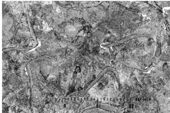
Şekil 3.6. Lamel grafitli dökme demir içinde bakır alaşım elementi (560X) (WEB_6 2004)
