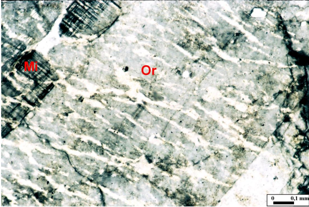
Şekil 3.5: Pertitik dokuya sahip iri ortoklas kristali (Or: Ortoklas, Mi: Mikroclin) (Çift Nikol; Kayalılık Tepe)
