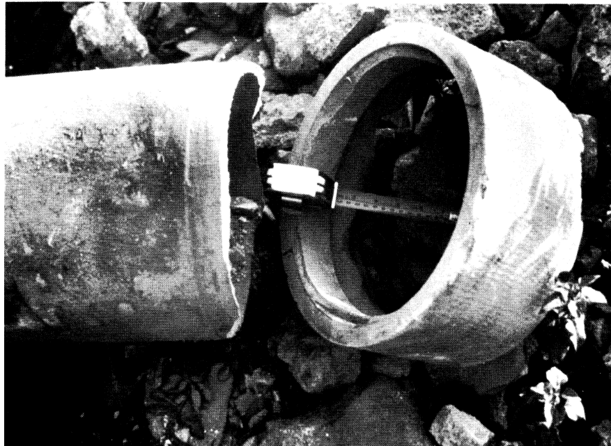
Şekil 4.5 1985 Michoacan Meksika depreminde asbest boruda bağlantı noktasında meydana gelen kırılma (Ayala ve O'Rourke 1989)
