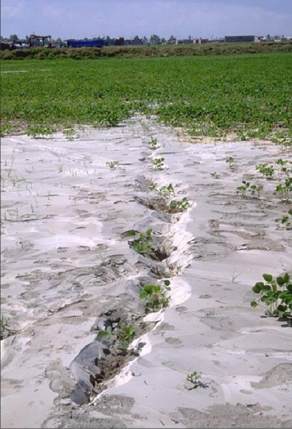
Şekil 4.9: 1998 Adana-Ceyhan depremi neticesinde Ceyhan nehrinin sağ sahilinde meydana gelen zemin sıvılaşması ile yüzeyde oluşan kum kaynaması.
