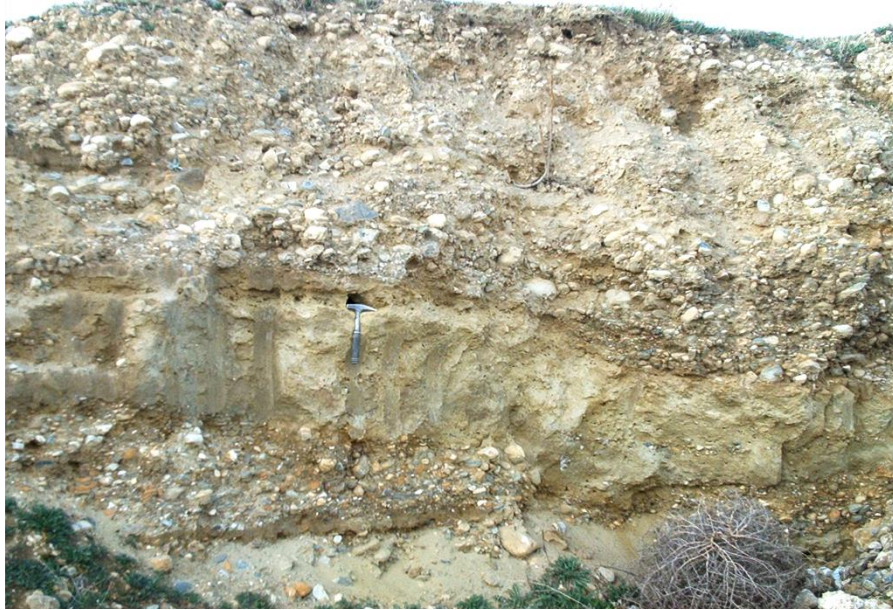
Şekil 3.5: Silt-Kum-Çakıl ardalanmasının arazideki görünümü.
