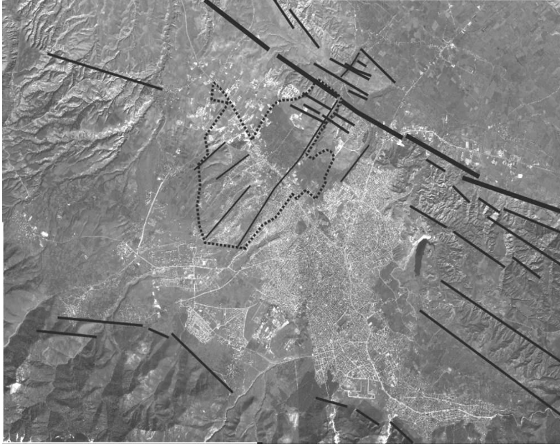
Şekil 3.13: Çalışma alanı ve yakın çevresinin uydu fotoğrafı. Noktalı kesik çizgilerle gösterilen yer Gümüşler belediyesi mücavir alanıdır. Fotoğrafın sağ üst köşesine yakın kısımdaki en kalın siyah çizgi Bozburun Fayını göstermektedir.
