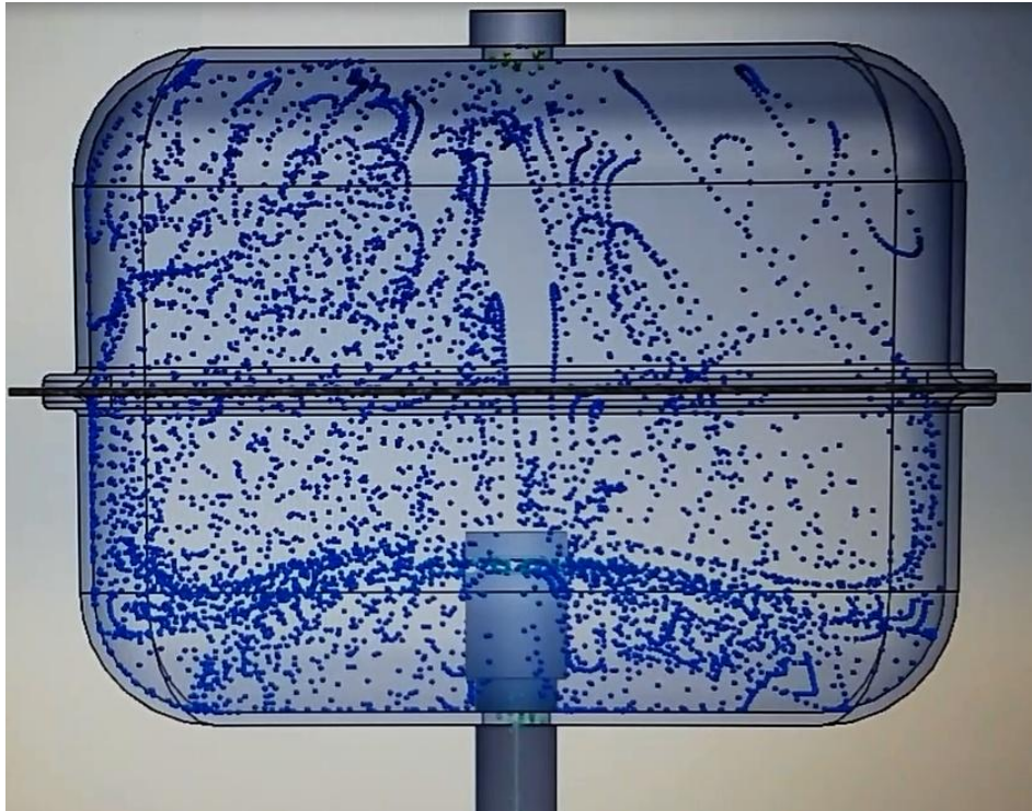
Şekil 3.1: Pamuk havlu kumaşın cam fanus içerisinde ozonlanması işleminin solid works simülasyon çizim görüntüsü- 1
