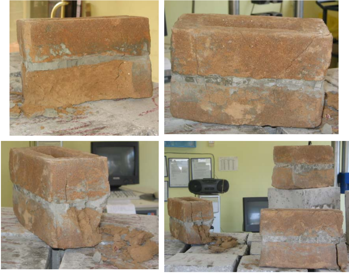
Şekil 5.21 : Basınç Deneyi Sonucu Tahrip Olan Numuneler
