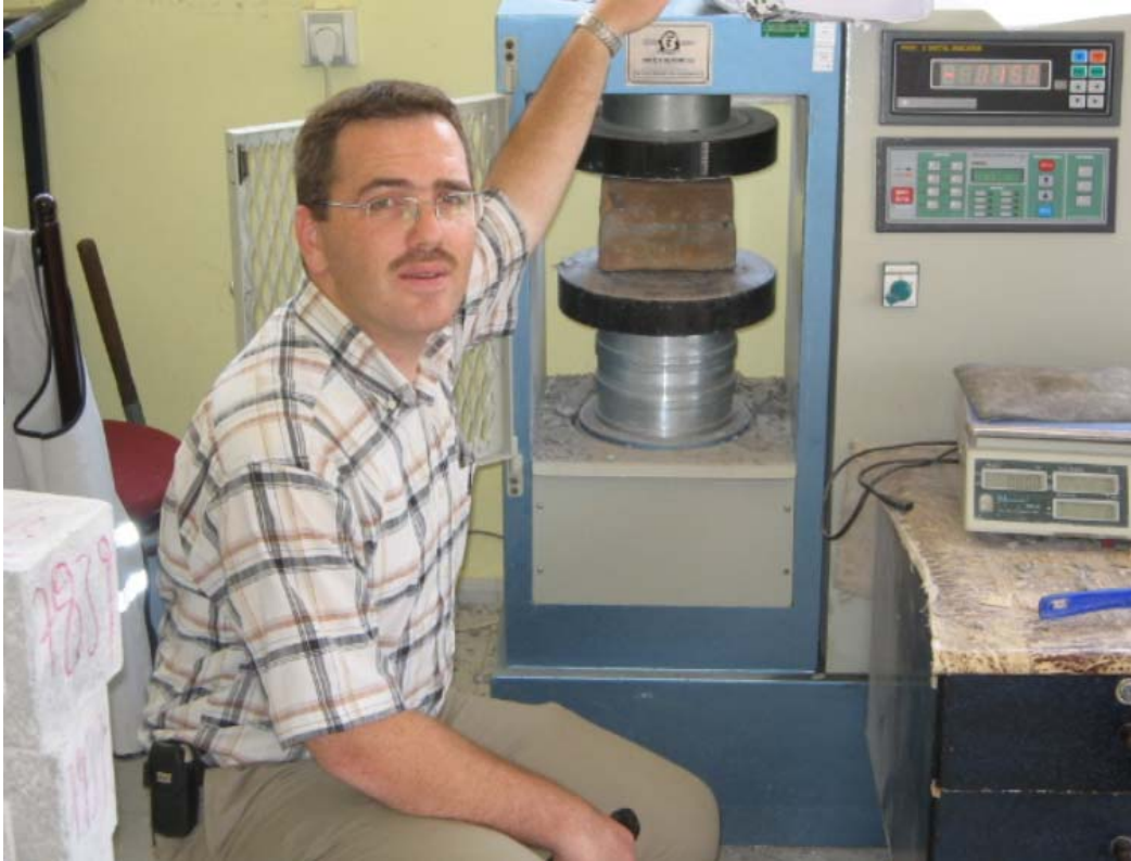
Şekil 5.18 : Harman Tuğlası Basınç Deneyi
