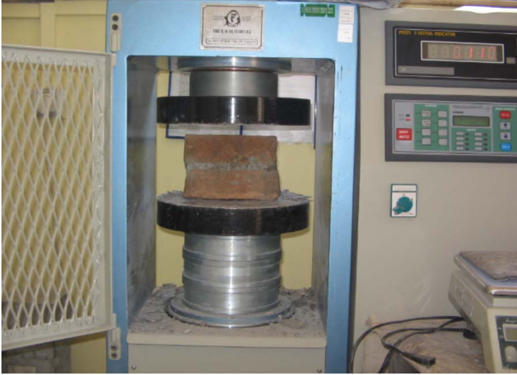
Şekil 5.19 : Harman Tuğlası Basınç Deneyi
