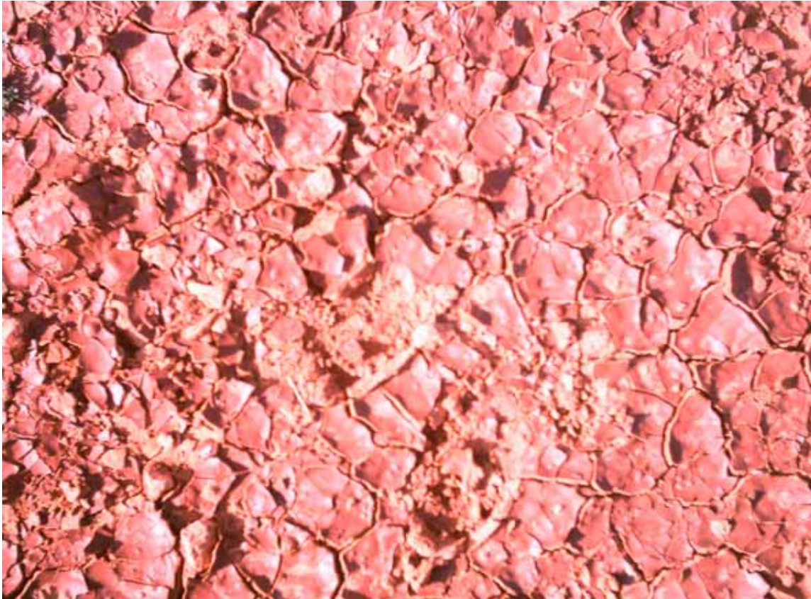
Şekil 4. 22 Uygulan yöntemlerle demir oksit anomalileri şeklinde belirlenen alanlarındaki kurumuş kırmızı çamurlar.
