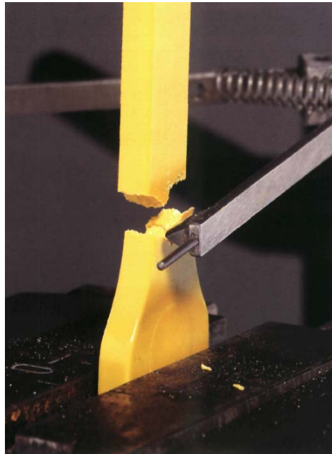
Şekil 2.9. Çekme Deneyi Sonrası Numune ve Uzama Ölçer
