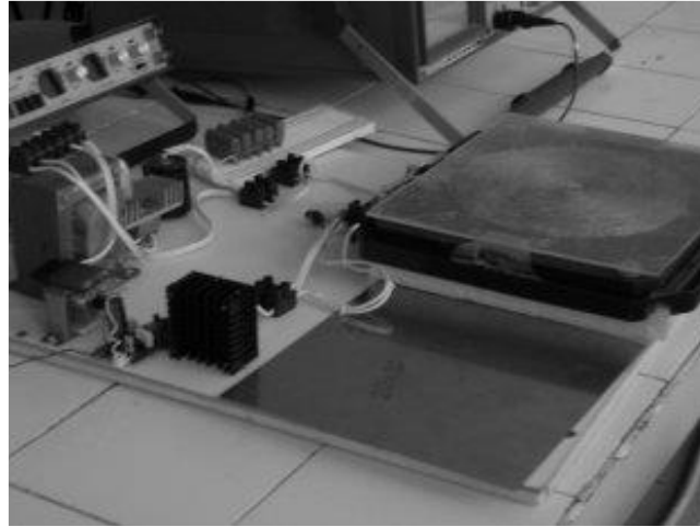
Şekil 5.3: Bir fazlı E sınıfı invertörlü mutfak tipi indüksiyon ısıtma deney düzeneği.
