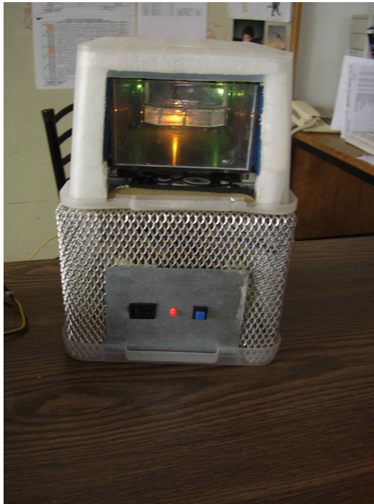
Şekil 3.16 Soğutucu maket soğutma konumunda çalışır konumdayken
