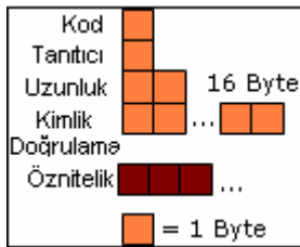
Şekil 2.2 Bir RADIUS paketinin genel yapısı
