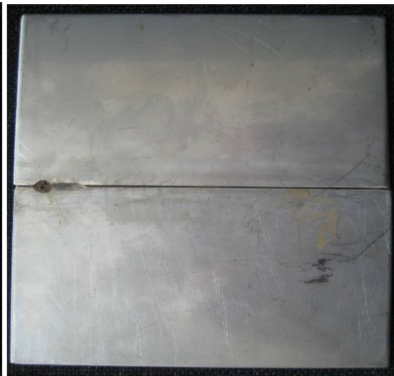
Şekil 4.7 600 min -1 , 60 mm/min, 5 kN, 1,5° ve 0,5 mm takım daldırma için zamana bağlı yük (a) ve sıcaklık (b) değişimi ile kaynak dikişinin üst (c) ve kök kısmı (d) görünümü
