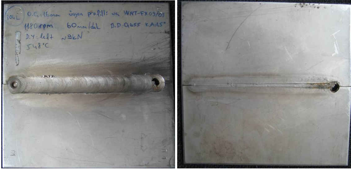
Şekil 4.12 1180 min -1 , 60 mm/min, 7,8 kN, 1,5° ve 0,6 mm takım daldırma için zamana bağlı yük (a) ve sıcaklık (b) değişimi ile kaynak dikişinin üst (c) ve kök kısmı (d) görünümü
