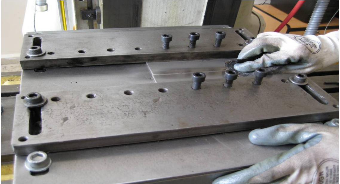
Şekil 3.3 Deney öncesi deney numunesi üzerinden zımpara ile oksit tabakasının kaldırılması
