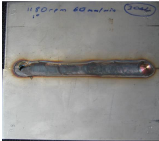
Şekil 4.14 1180min -1 , 60 mm/min, 7,8 kN, 1° ve 0,465 mm takım daldırma için zamana bağlı yük (a) ve sıcaklık (b) değişimi ile kaynak dikişinin üst (c) ve kök kısmı (d) görünümü
