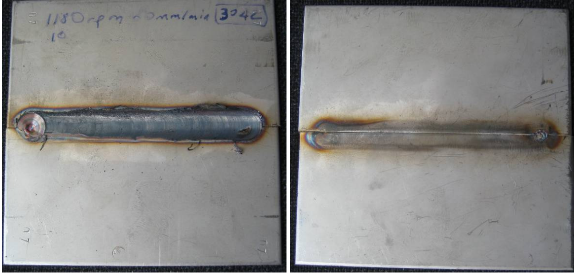
Şekil 4.15 1180 min -1 , 60 mm/min, 7 kN, 1° ve 0,72 mm takım daldırma için zamana bağlı yük (a) ve sıcaklık (b) değişimi ile kaynak dikişinin üst (c) ve kök kısmı (d) görünümü
