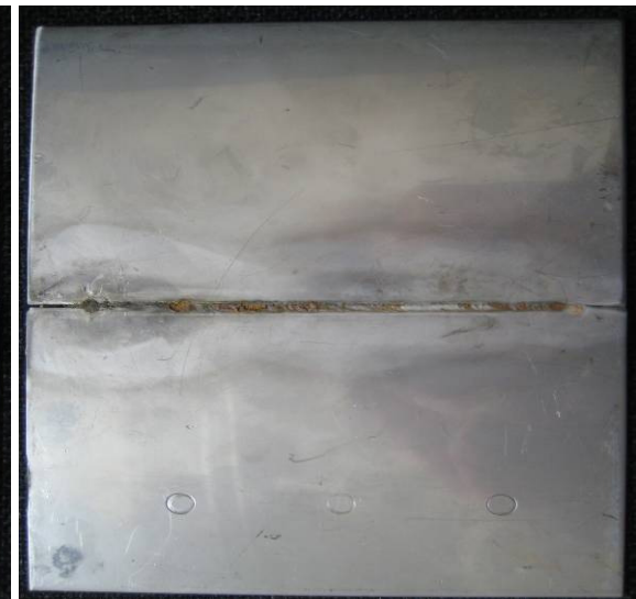
Şekil 4.4 600 min -1 , 47,5 mm/min, 5kN, 0° ve 0,6 mm takım daldırma için zamana bağlı yük (a) ve sıcaklık (b) değişimi ile kaynak dikişinin üst (c) ve kök kısmı (d) görünümü
