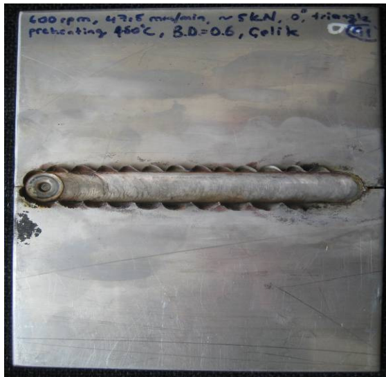
Şekil 4.4 600 min -1 , 47,5 mm/min, 5kN, 0° ve 0,6 mm takım daldırma için zamana bağlı yük (a) ve sıcaklık (b) değişimi ile kaynak dikişinin üst (c) ve kök kısmı (d) görünümü
