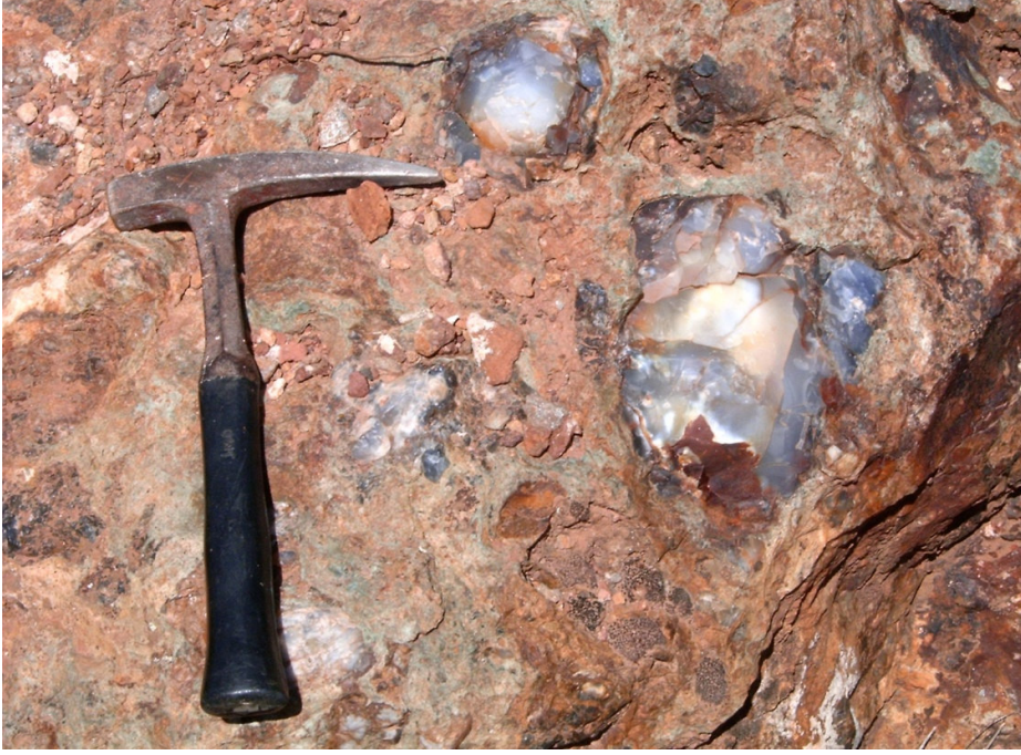
Şekil 2.17 Kilimli Çakıltası tabanında, süreksizlik yüzeyleri boyunca hidrotermal silis getirimi sonucu oluşmuş olan kalsedon oluşumları.
