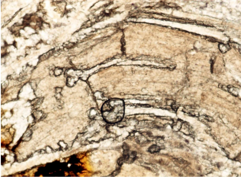
Şekil 2.13 Tamamen karbonatlaşmış peridotit. Sekonder mineraller kayacın yapı ve dokusal karakterine uygun olarak yerleşmiştir. Fotoğrafın sol altında kenarları hematite dönüşmüş kromit görülmektedir (10X, tek nikol).
