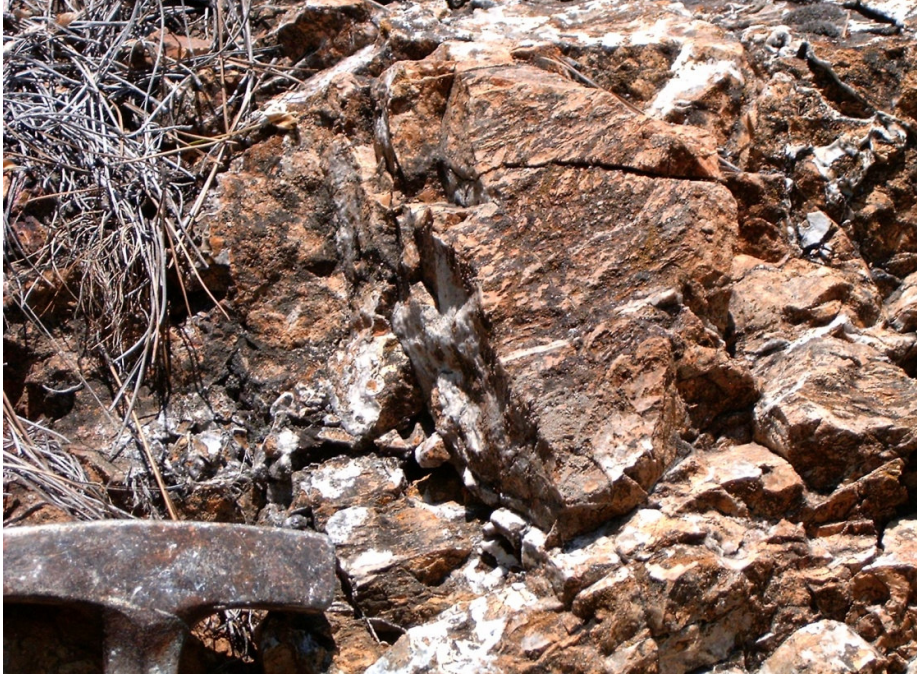
Şekil 2.19 Daha az alterasyona uğramış olan granitoyit. Kayaç yapısal özelliklerini kısmen korumaktadır.
