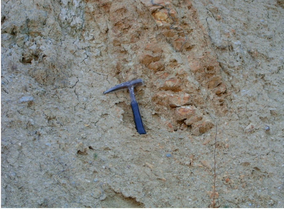
Şekil 2.2 Mayıslar granitoyitine yakın olan kesimlerde yol yarmasında yüzeylenen şistlerde görülen alterasyon
