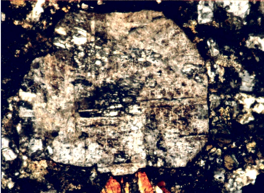
Şekil 2.23 Bir tüfit örneğinde öz şekilli piroksen kristalinin mikroskopta görünümü (10X, çift nikol)
