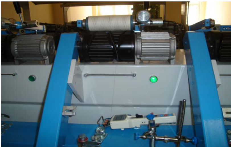
Şekil 3.2 Bobinleme makinesinde gerilim ölçme düzeneği
