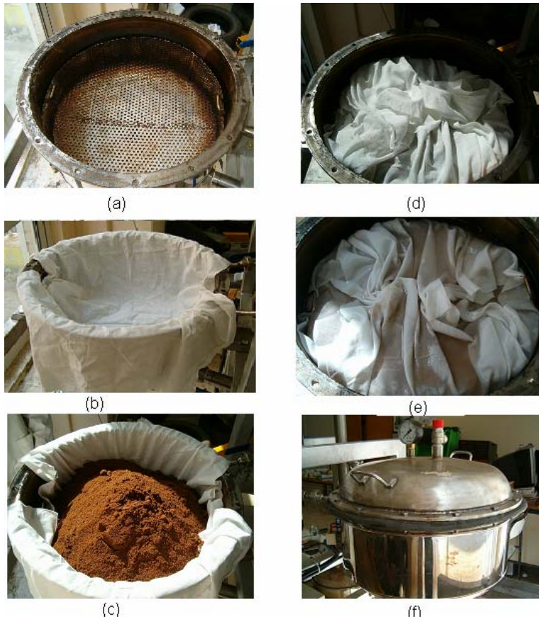
Şekil 5.5 Tütün tohumundan yağ çıkarılmasının safhaları a) Tohum haznesinin boş şekli, b) Tohumların haznede kalmasını sağlayan tülün hazneye konması, c) Tohumun hazneye konulması, d) Tohumların tül ile örtülmesi, e) Tohumlara dietilelerin eklenmesi, f) Hazne kapağının kapatılması.
