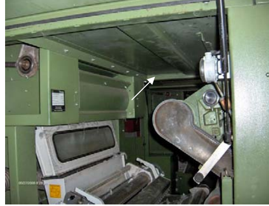
Şekil 5.15 Caraskal aparatının takılacağı girintili iç tavan
