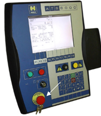
Şekil 5.6 CNC kumanda panosu durdurma butonu
