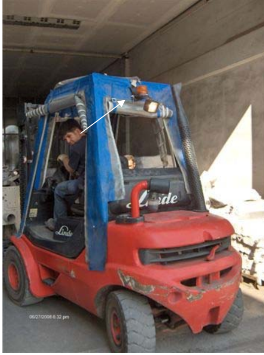
Şekil 5.23 Forklift sesli ve ışıklı ikaz tertibatı
