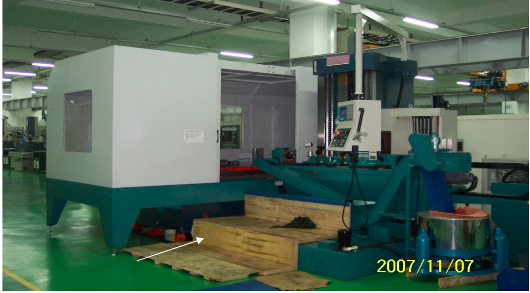
Şekil 5.17 Derin delik delme tezgâhı - tasarım dışı ilave çalışma platformu
