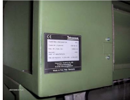
Şekil 5.22 Yönetmeliğe uygun makine işaretleme
