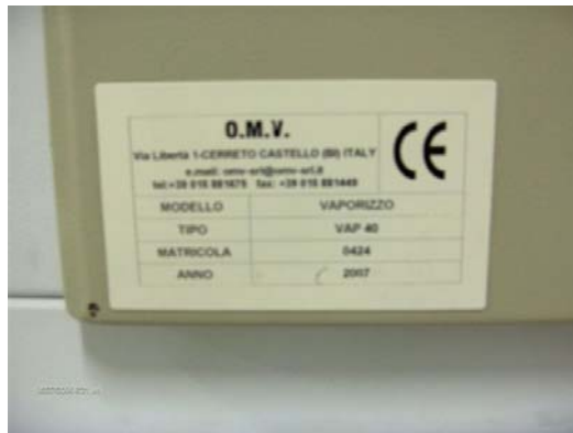
Şekil 5.21 Yönetmeliğe uygun makine işaretleme
