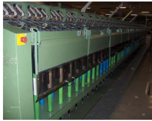
Şekil 5.8 Koruyucu kapaksız fitil makinesi Şekil 5.9 Koruyucu kapaklı fitil makinesi
