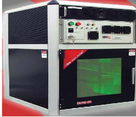
Şekil 5.10 Fiber lazer markalama cihazı lazer ışınlarını önleyici koruyucu kapağı
