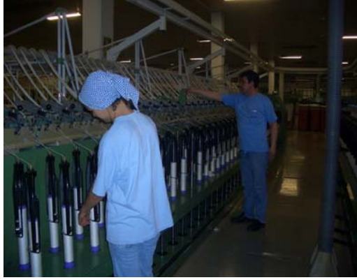
Şekil 5.8 Koruyucu kapaksız fitil makinesi Şekil 5.9 Koruyucu kapaklı fitil makinesi
