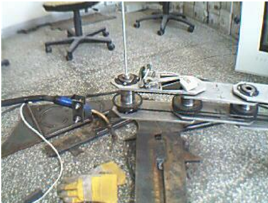
Őekil 4.13 Birinci uzva baęlanan kaynak torcu
