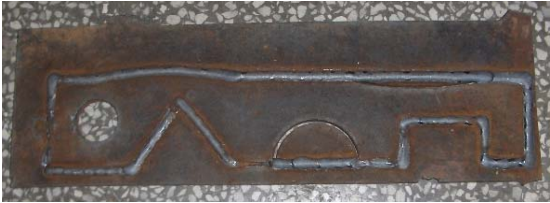
Şekil 4.14 Autocad programından alınan çizime göre yapılmış kaynak denemesi
