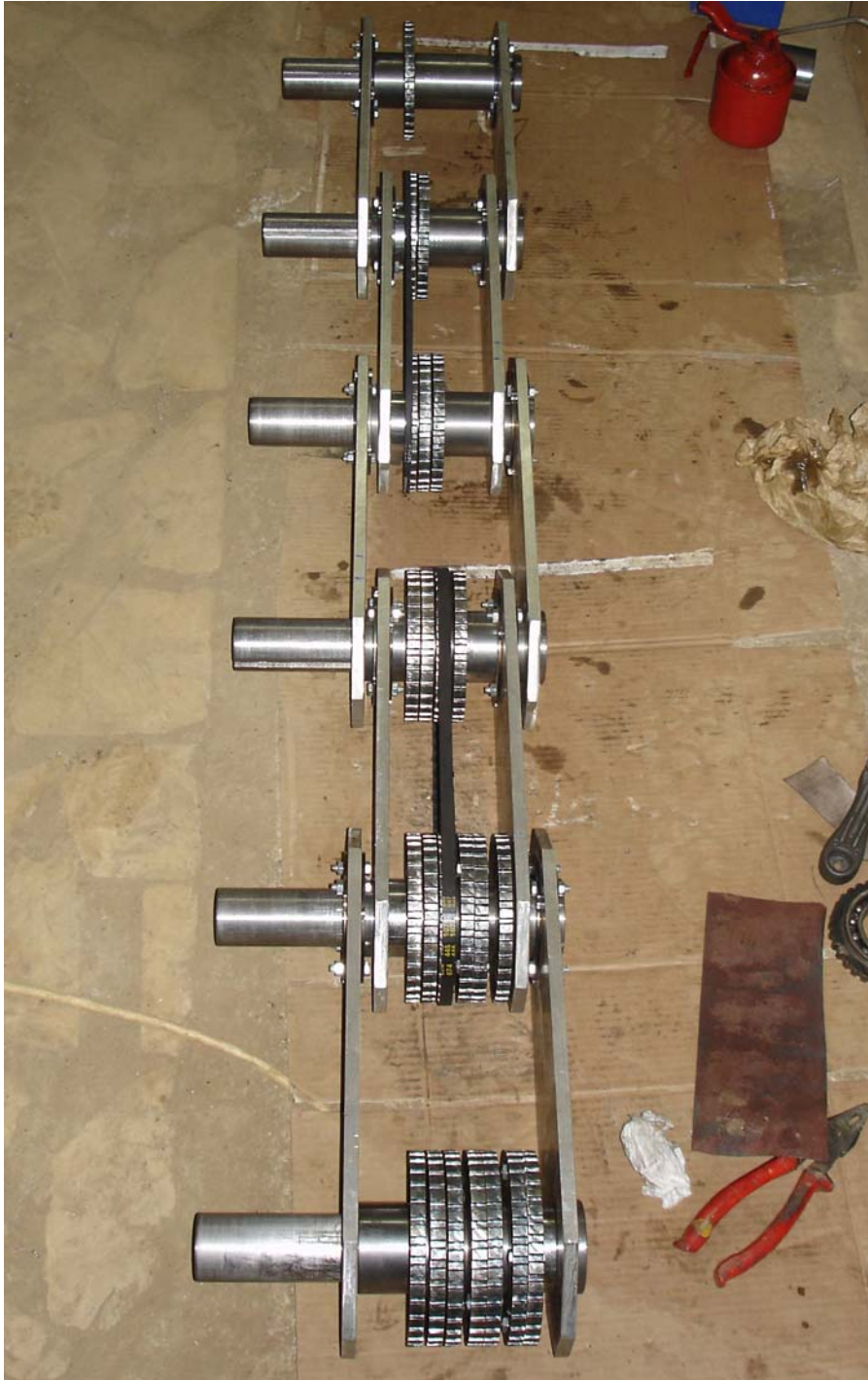
Şekil 4.8 Triger kayışları takılmadan montajı yapılmış robot kolu
