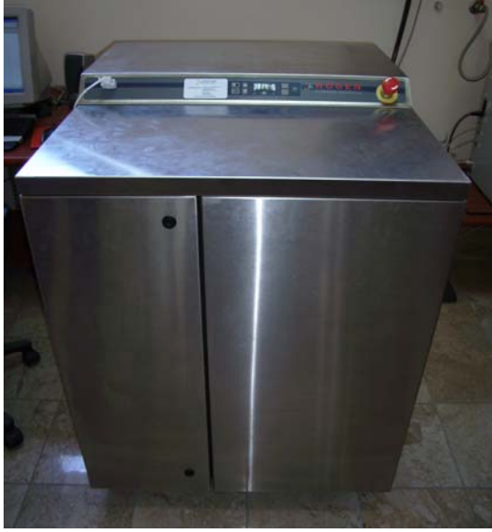
Şekil 4.10 Suyun elektrolizini sağlayarak hidrojen elde edilmesinde kullanılan elektrolizör ünitesi.
