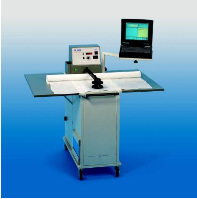
Şekil 2.11 Hava geçirgenliği test cihazı (WEB_4 2007)
