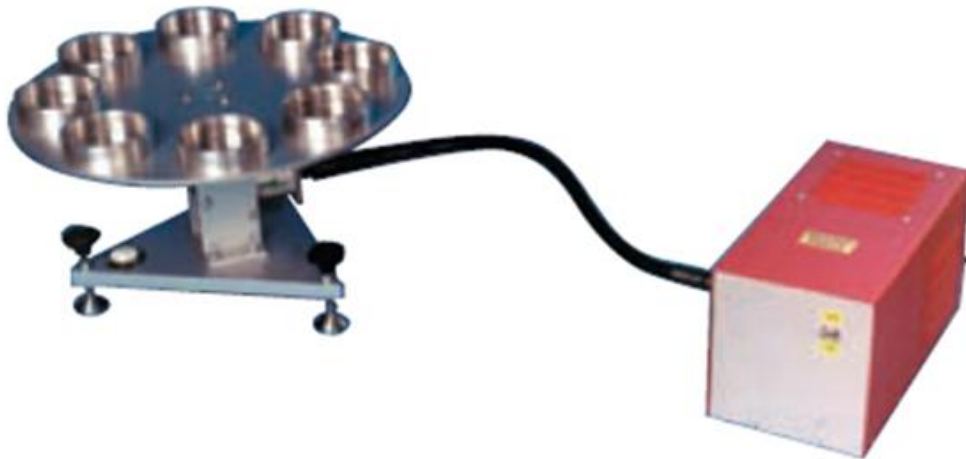
Şekil 2.12 Shirley su buharı geçirgenliği test cihazı (WEB_8 2007)
