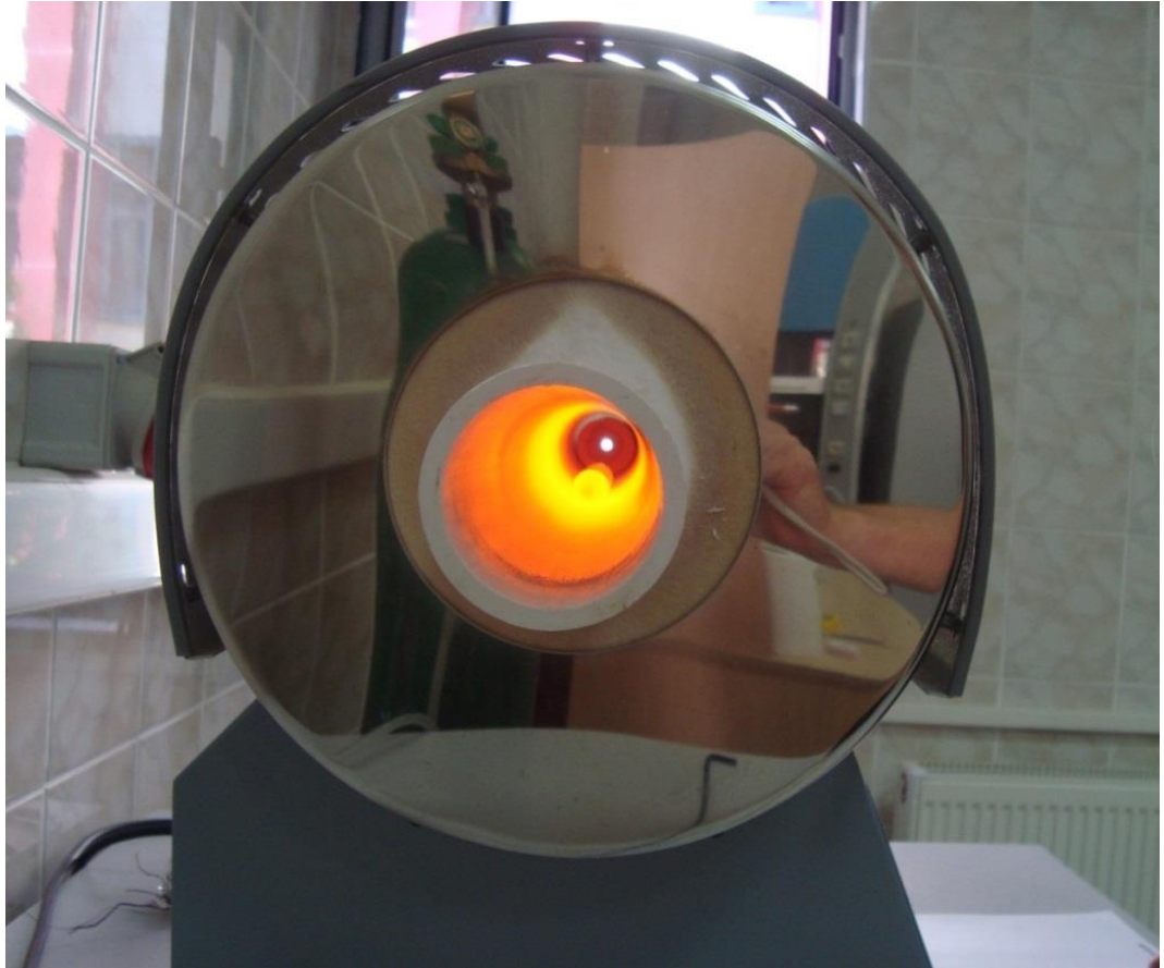
Şekil 3.5: Protherm marka yatay tp fırında sinterleme iřlemi
