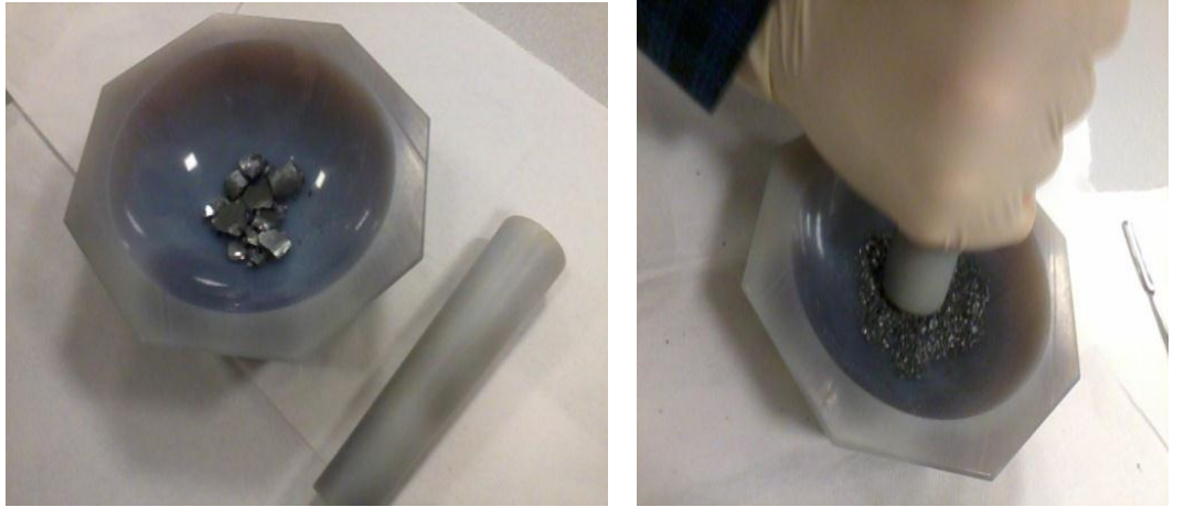
Şekil 3.7: Külçe halindeki bileşiğin agat havanda toz haline getirilmesi
