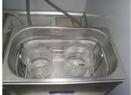
Şekil 3.9: ITO kaplı alttaşların saf su ve ultrasonik temizleme cihazında temizlenmesi
