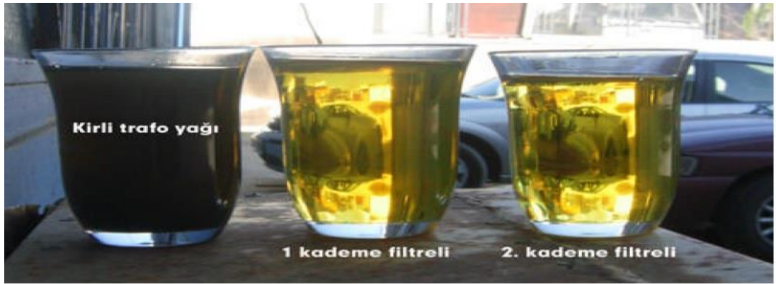
Şekil 2.10: Yağın filtrelenerek iyileştirilmesi
