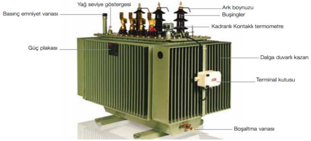
Şekil 2.8: Hermetik tip yağlı transformatör yapısı
