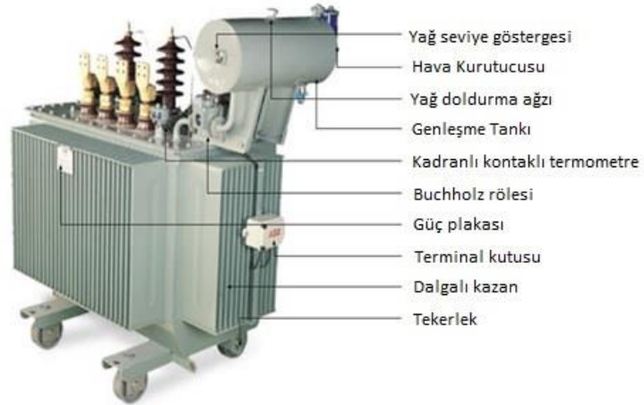
Şekil 2.9: Genleşme depolu yağlı transformatör yapısı
