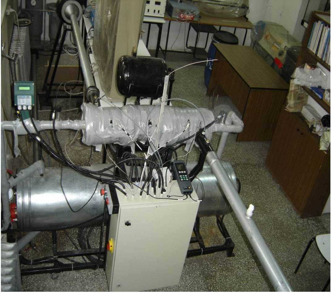
Şekil 4.6 Çalışmada kullanılan, Üniversitemizin maddi desteği ile imalatını gerçekleştirdiğimiz kanat - boru tipi ısı değıştiricisi ile ilgili deney düzeneğinin resmi
