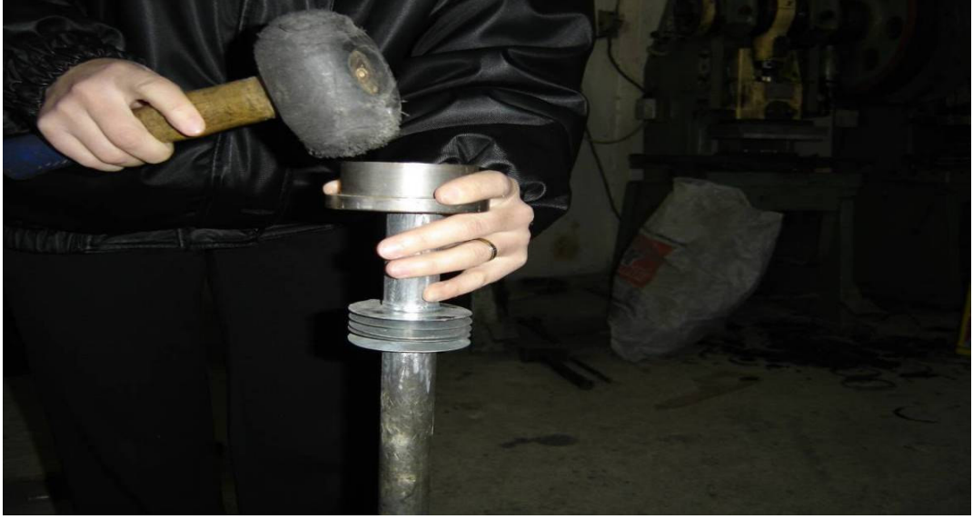
Şekil 4.10 Kanatın boruya çakılmasında yardımcı aparatın kullanılması
