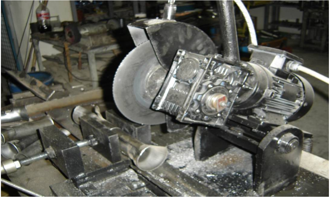
Şekil 4.8 Isıtıcı borunun elektrikli testere ile kesilmesi
