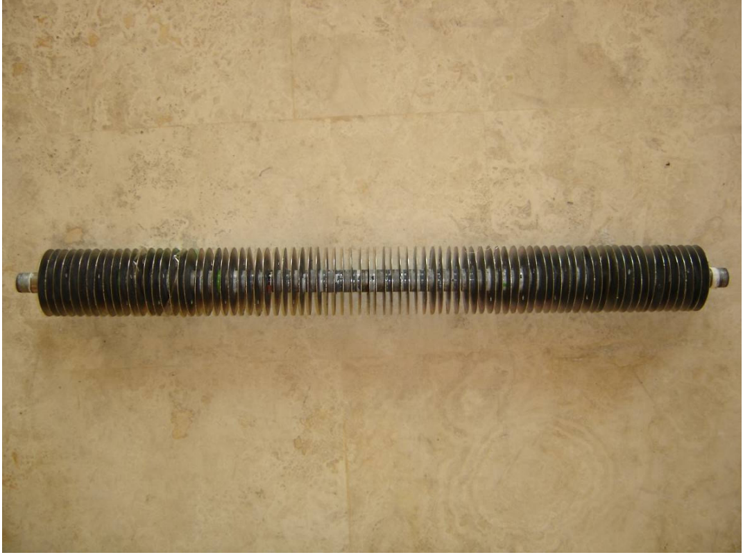
Şekil 4.12 Her iki yanına standart boru dişi açılan kanatlı boru
