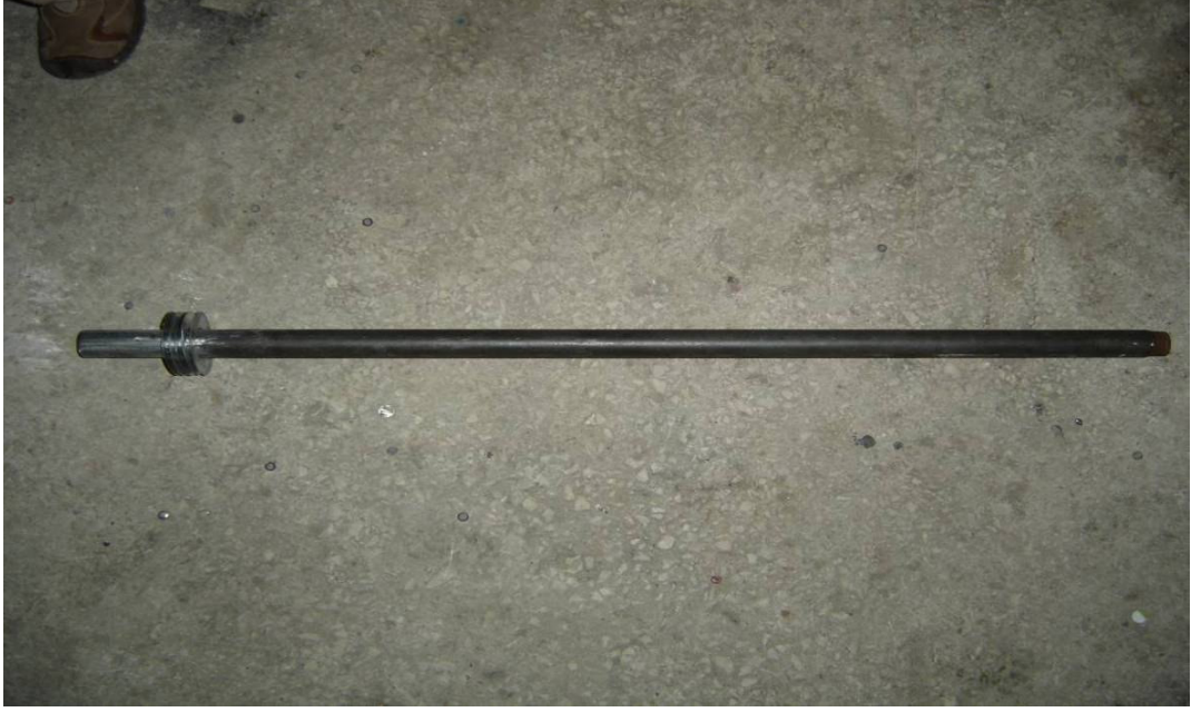
Şekil 4.7 Üzerine sac kanat geçirilmeden önceki ısıtıcı boru
