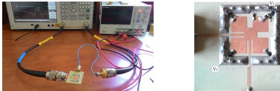
(a) (b) Şekil 4.12: (a) Ölçüm düzeneği, (b) üretilen ayarlanabilir filtrenin fotoğrafı.
