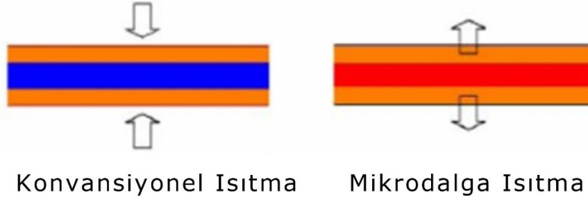
Şekil 3.7: Konvansiyonel ısıtma ve mikrodalga ısıtma mekanizması (Ahmed ve El-Shishtawy 2010)
