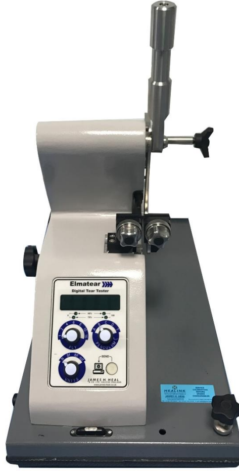
Şekil 4.6: Elmatear Dijital Teat Tester yırtılma mukavemeti test cihazı
