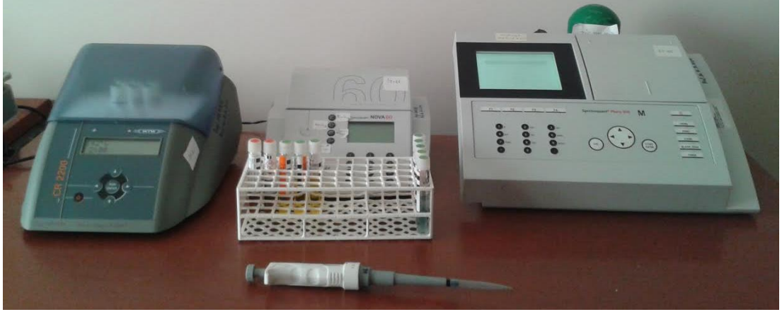
Şekil 4.7: KOİ ölçümlerinde kullanılan Standart titrimetrik yöntemine göre, gerçekleştirilen işlemler sırasında WTW CR 2200 Reaktör, Merck UV Visible Spectroquant Pharo 300
