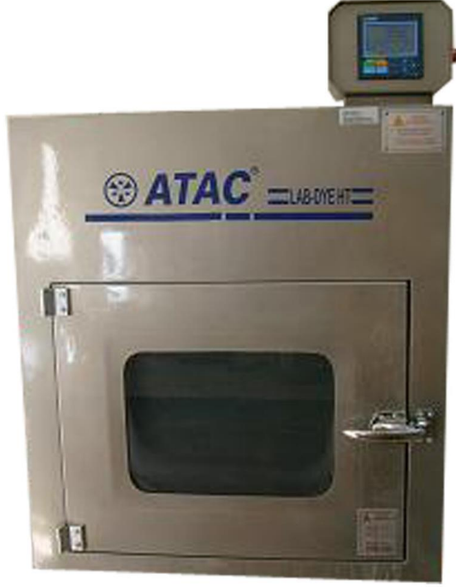
Şekil 4.1: Ananas liflerinin geleneksel ön terbiye işlemlerinin gerçekleştirildiği ATAÇ marka ATAÇ Lab Dye HT model IR numune boyama makinası
