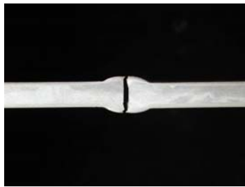
b. Kök aralığına sahip alın dikişi, Kırılma, kaynak metalinde ve kök aralığında
