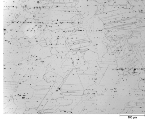
3. Kaynak dikişinde iç yapı
