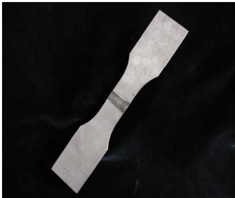
Şekil 3.8 Kök aralıklı alın dikişi; \rho_{ort} = 0,1 mm, K_t = 14,19
