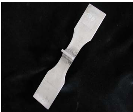
Şekil 3.9 Köşe dikişli enine dikme; \rho_{ort} = 0,56 mm, K_t = 2,03
