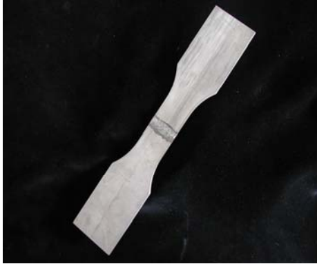
Şekil 3.7 Kök aralıksız çift V-dikişli alın dikişi; \rho_{ort} = 1,72 mm, K_t = 1,64
