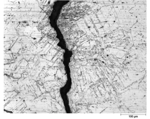
Şekil 3.24 Hasara uğrayan bir kök aralıklı alın dikişinde iç yapılar
