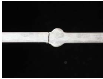
a. Tamamen kaynaklı alın dikişi, Kırılma, ısı tesiri altındaki bölgede ve dikiş geçiş bölgesinde
