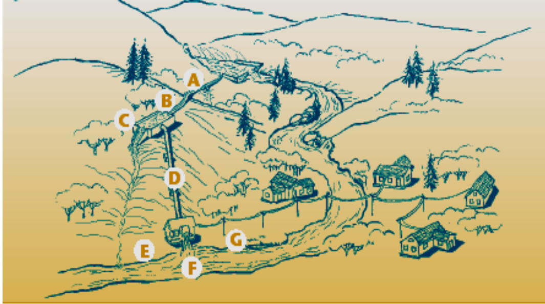
Şekil 8.1 Küçük hidroelektrik santral ilke taslağı (A.Çevirme Yapısı, B.Su iletim Sistemi, C.Yükleme Odası, D.Cebri Boru, E. Santral, F. Kuyruk Suyu tesisleri, G.Enerji Nakil Hattı)
