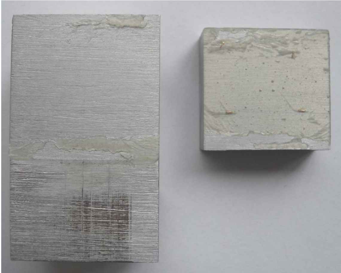
Şekil 2.4 Bağlantıda meydana gelen adhezyon hasarı
