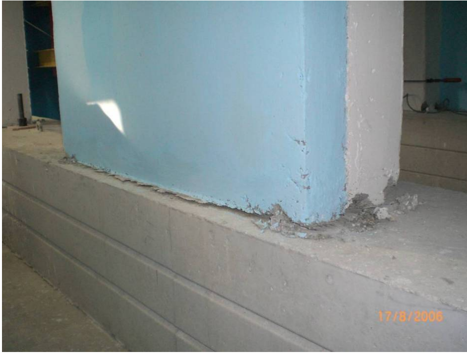
Şekil 4.45 Perdenin çekme bölgesinde kolon ve perdenin birlikte hareketi
