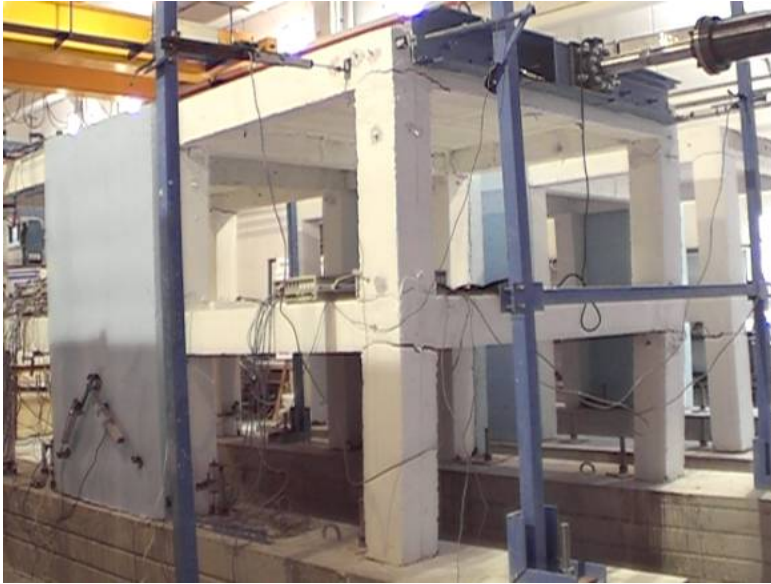
Şekil 4.30 Deneyin son iki çevriminde gözlenen davranış
