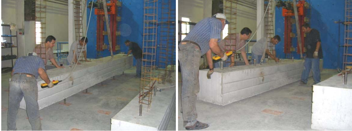
Şekil 3.18 Temelin taşınması ve kuvvetli döşemeye ankrajlanması
