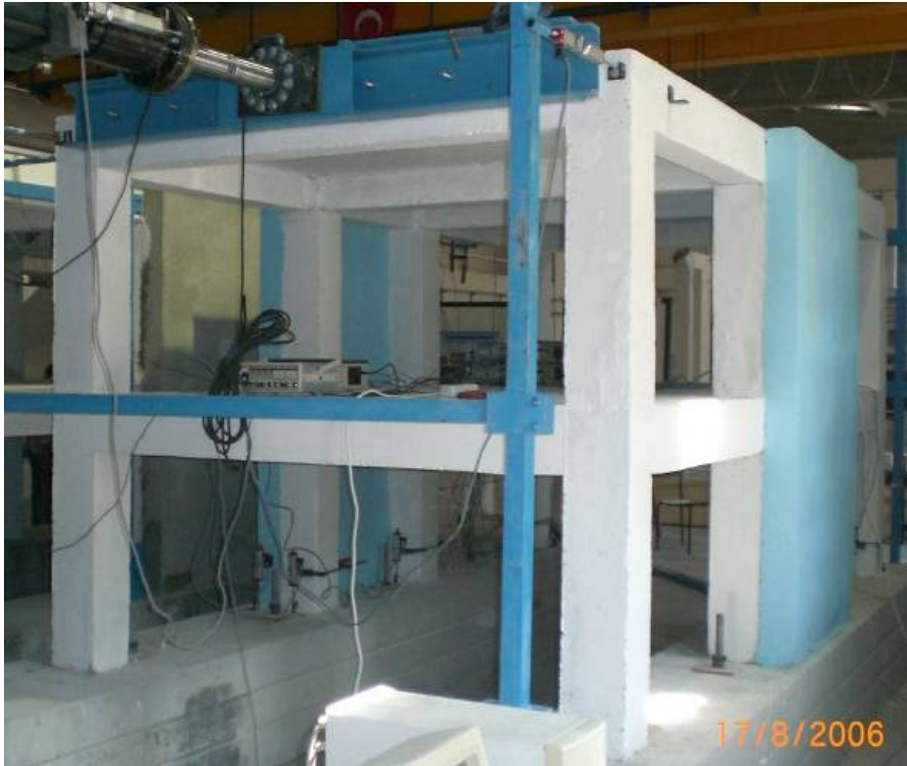
Şekil 4.33 Modelin deney öncesi son görünümü
