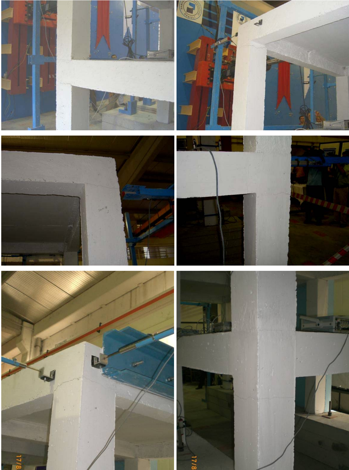
Şekil 4.42 Numunede ilk çatlak oluşumları
