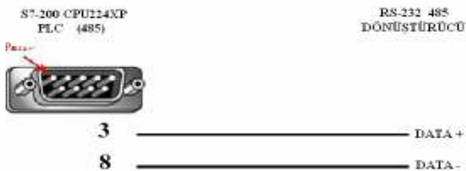
Şekil 3.8 Dönüştürücü ve S7-200 CPU224XP arasındaki bağlantı şeması
