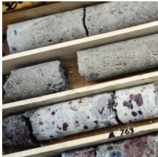
Şekil 36 : Jet enjeksiyon kolonlarından alınan karot örnekleri [W2]
