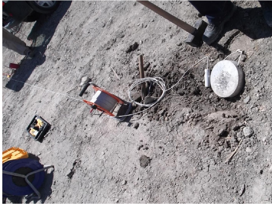
Şekil 25 : Sismik Deney Yöntemi ve Deney Ekipmanları [R1]
