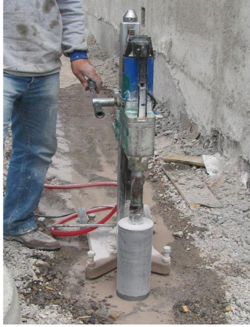
Şekil 18 : Karot Numunelerinin Alınması [Y2]
