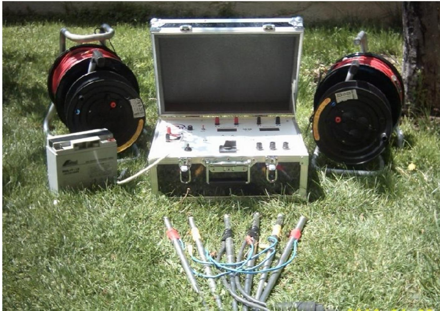
Şekil 26 : Rezistivite Deney Ekipmanları [R1]
