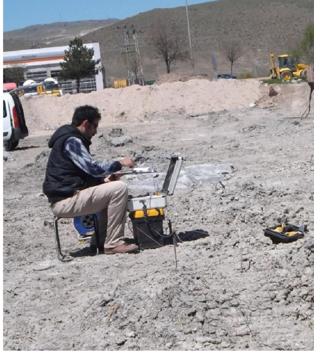
Şekil 27 : Rezistivite Deney Yapılışı [R1]
