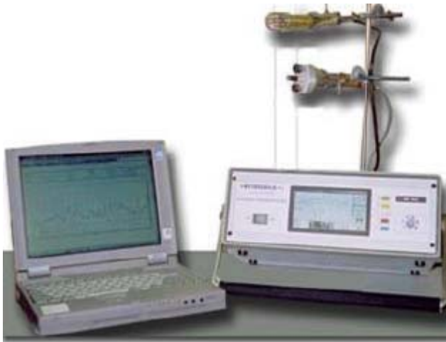
Şekil 2.16 Kaydedici R-2000 modeline sahip Rothschild elektronik gerginlik ölçüm cihazı (Narayana 2005)
