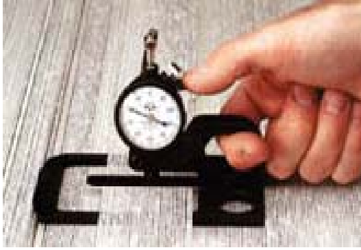
Şekil 2.15 Shirley çoklu iplik gerginlik ölçümü yapan cihaz (Narayana 2005)
