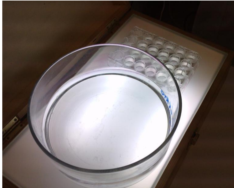
Şekil 5.14 Ceriodaphnia dubia ile Toksisite Deney Düzeneği
