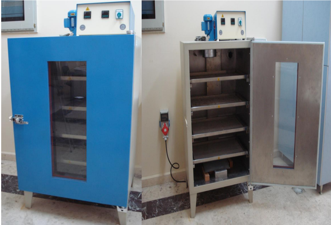
Şekil 3.1. Tepsili kurutma kabininin genel görünümü
