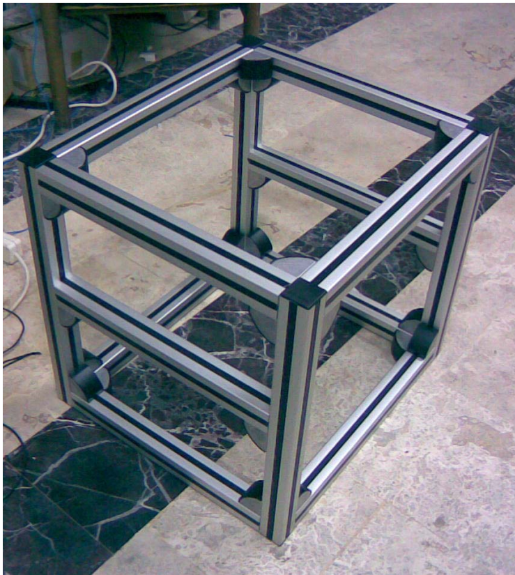
Şekil 2.1 Profil kafes sistemi
