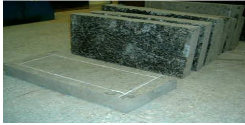
Şekil 5.20: Fransız tekerlek izi deney cihazında kullanılan numuneler
