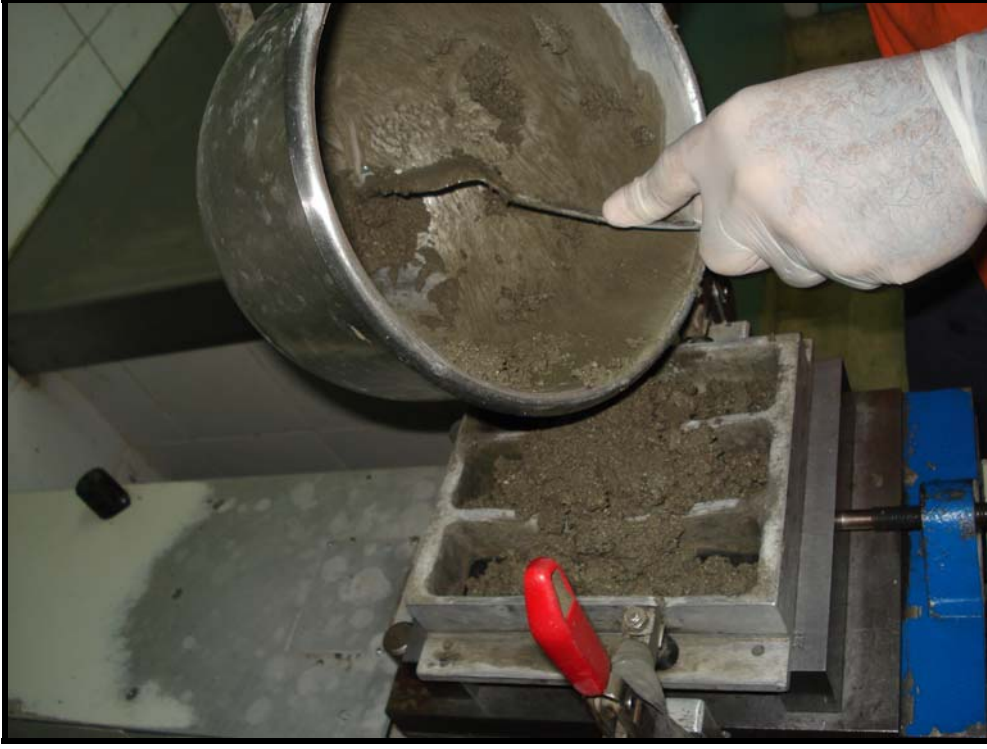
Resim 2.6 Karışımın kalıba yerleştirilmesi
