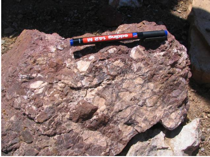
Şekil 5.39 Breşik barit ve barit tanelerinin arasını dolduran demirli mineraller (hematit, limonit)
