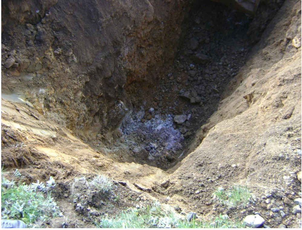
Şekil 6.13 : H – 1 yarmasında 4 m derinlikte görülen silisli zonun görünümü
