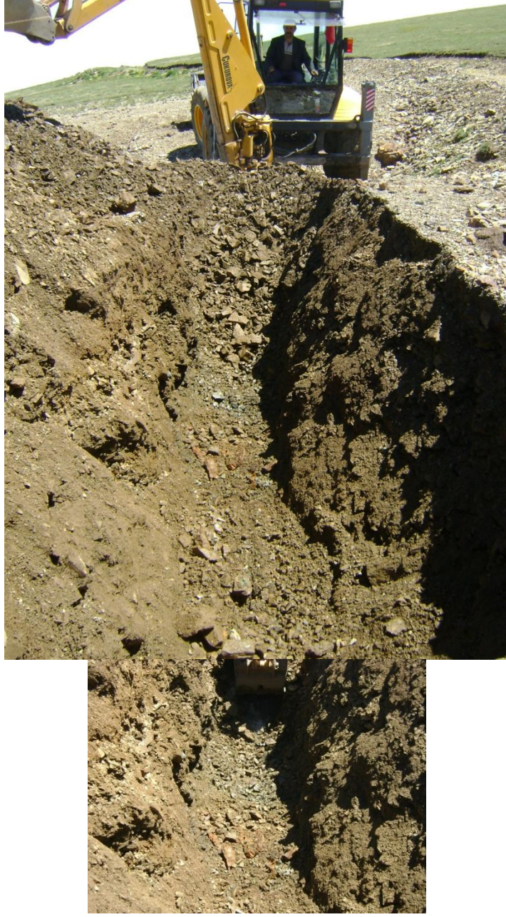
Şekil 6.8 : D-2 yarmasında 3,5 m derinde belirlenen silisli zonun görünümü (KD bakış).
