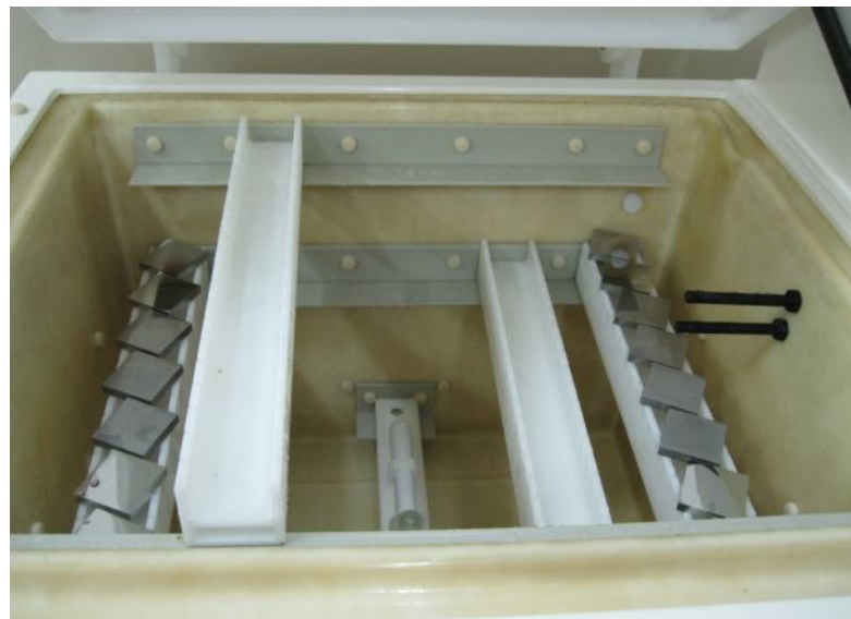
Őekil 4.20 : Tuz spreyi deneyi numune yerleřimi
