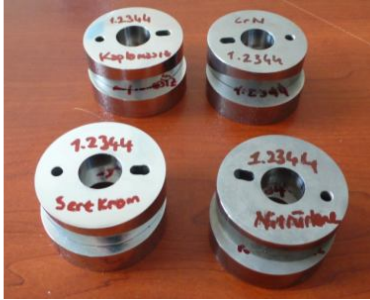
Şekil 4.15 : X40CrMoV5-1 (Malzeme No 1.2344) Aşınma deneyi numuneleri
