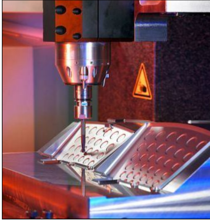
Şekil 2.8 : CNC dik işlem merkezinde kalıp çekirdeği imalatı
