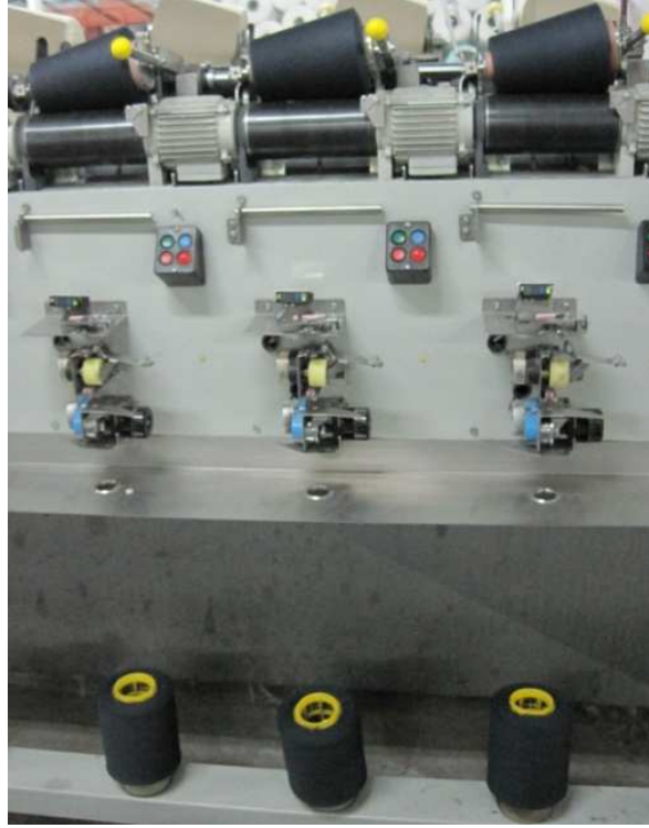
Şekil 3.4. Boyanmış patronlardan sert sarım makinelerinde renk numuneleri alınırken
