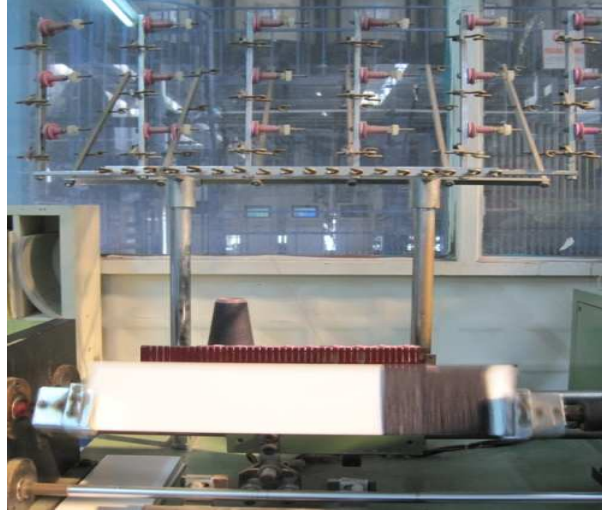
Şekil 3.5. Konik kartondaki renk numuneleri kartlara sarılırken
