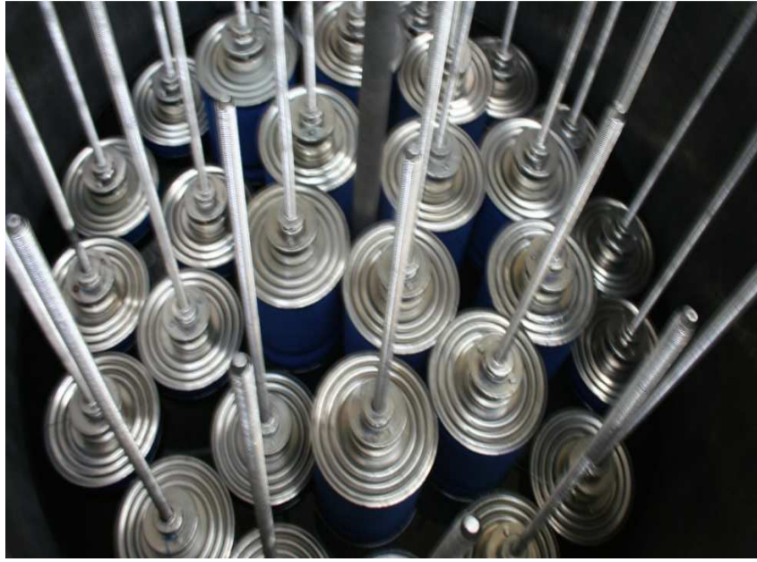
Şekil 2.1. Bobin boya makinesinin içindeki metal tüplerin ve bobinlerin yerleşimi (Küçüker Tekstil)
